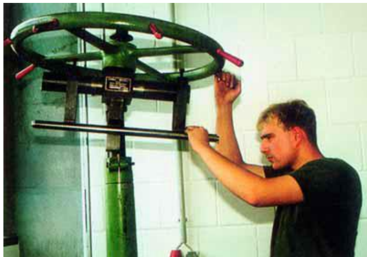
После проковки ствол проверяется мастером на наличие искривлений
