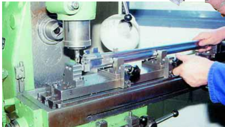
Стволы фрезеруют на специальном станке
