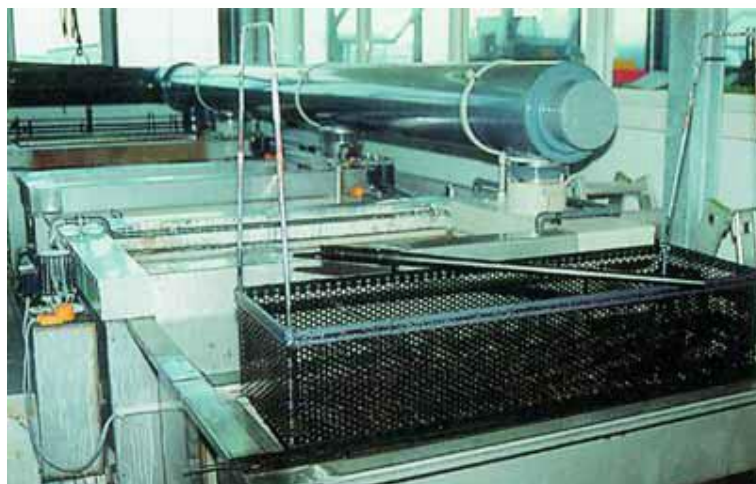
Отдельные стволы подвергаются воронению (оксидированию) в специальной ванне. Спаянные стволы погружать в эту ванну нельзя, т.к. кислота, содержащаяся в оксидирующем растворе, разъедает пайку
