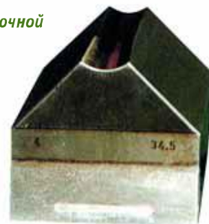
Специальное сверло при прохождении сквозь заготовку точно выдерживает заданное направление
