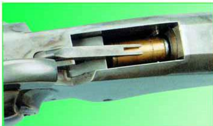
Вид затворной коробки сверху: положение патрона перед досыланием его в патронник
