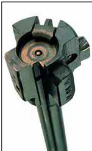
Затвор с тремя боевыми упорами. Ударник оснащён противознерционной пружиной
