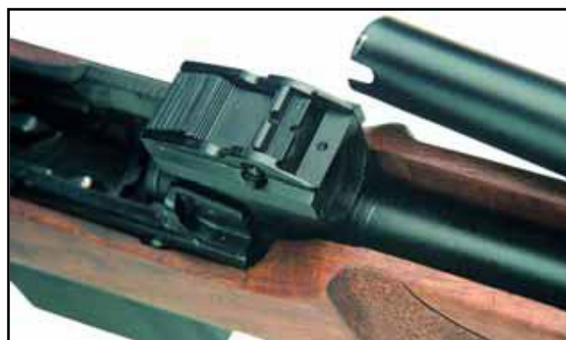
Газовая трубка стала «быстросъёмной» благодаря новому креплению. На фото виден перекидной целик прицела
