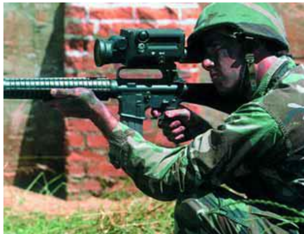
Инфракрасный прицел Raytheon W1000 на винтовке M16. Такой прицел обеспечивает эффективную стрельбу даже в условиях полной темноты
