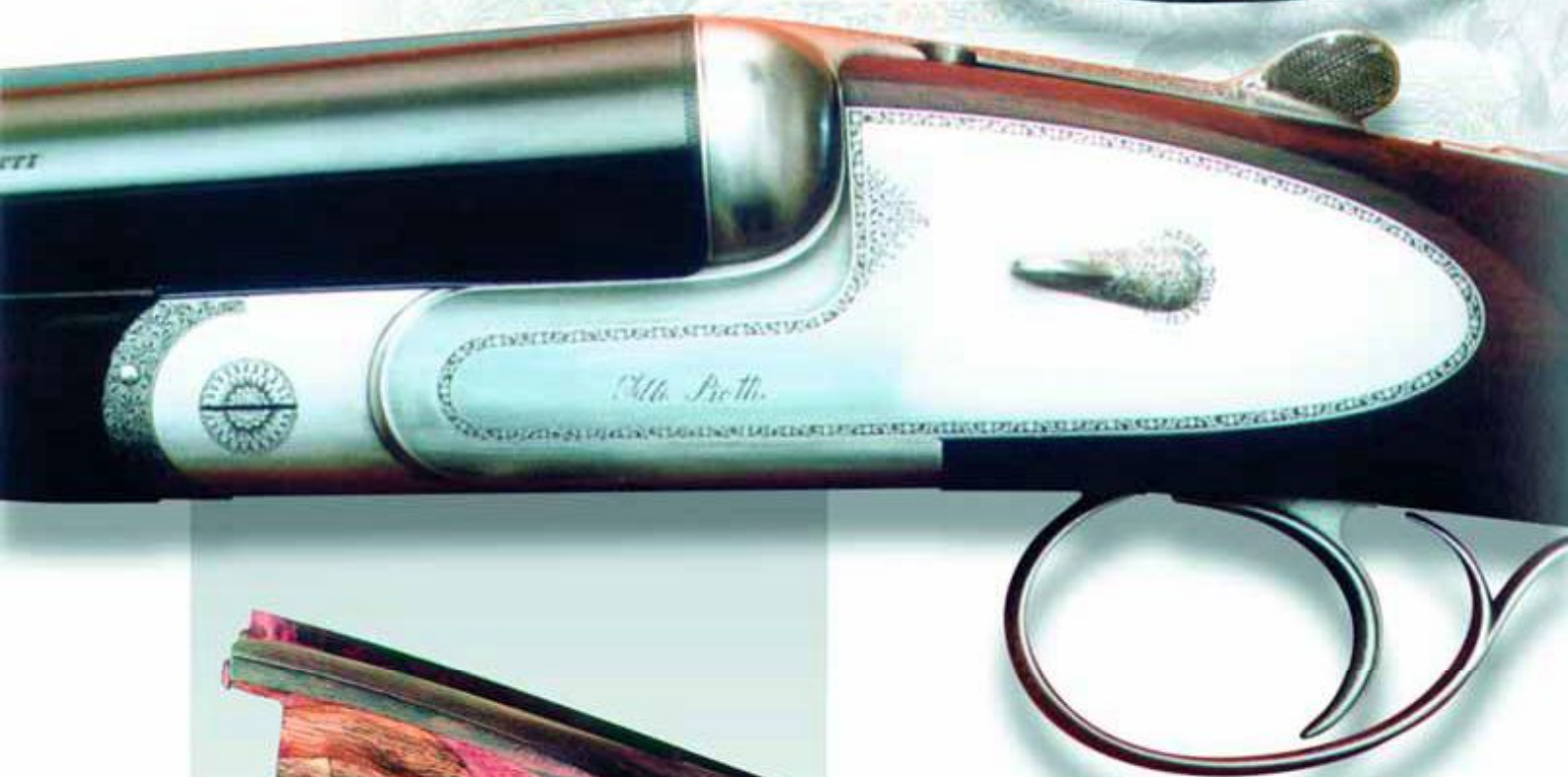
Бескурковая двустволка с одним спусковым крючком, с рычагом ручной разборки. Замочные доски без шпипек
