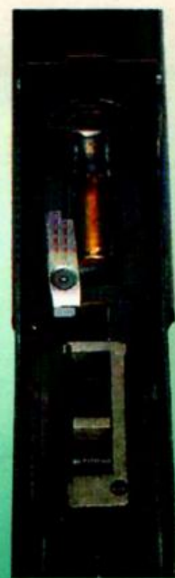
Вид затворной коробки сверху. Хорошо виден патрон в шнековом магазине
