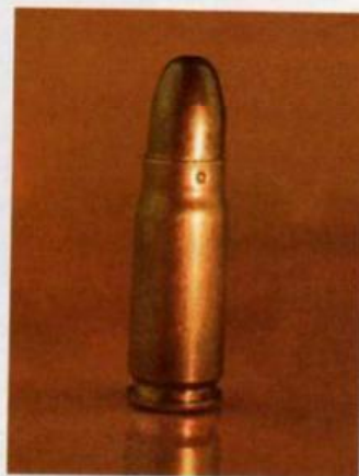
7,62-мм патрон образца 1930 года с пулей со свинцовым сердечником и латунированной оболочкой. Гильза — латунная. Военный выпуск
