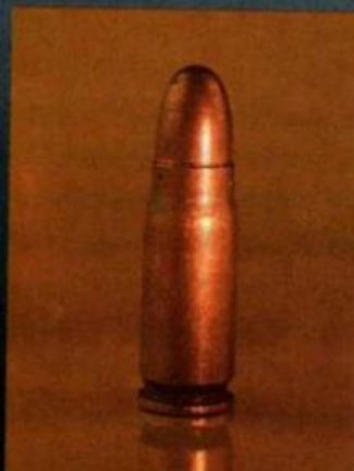
7,62-мм патрон образца 1930 года с пулей со свинцовым сердечником и биметаллической оболочкой. Гильза — биметаллическая. Военный выпуск
