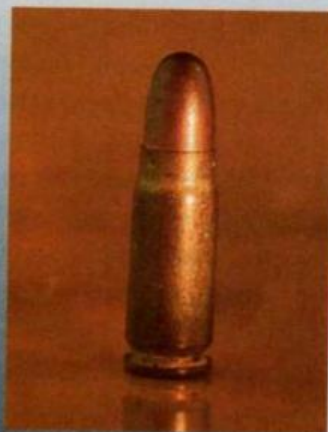
7,62-мм патрон образца 1930 года с пулей со свинцо- вым сердечником и стальной оболочкой. Гильза — стальная, лату- нированная
