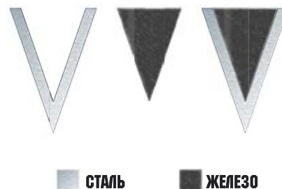
Kobushi – вариант сварки пакета, когда заготовка из мягкого железа треугольной формы покрывается с двух сторон тонким слоем стальных обкладок, образующих режущую кромку клинка (Схема сборки пакета)
