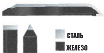
Sueha – сварка пакета, когда стальная заготовка приваривается к железному стержню, чтобы обеспечить качество режущей кромки. (Схема сборки пакета)
