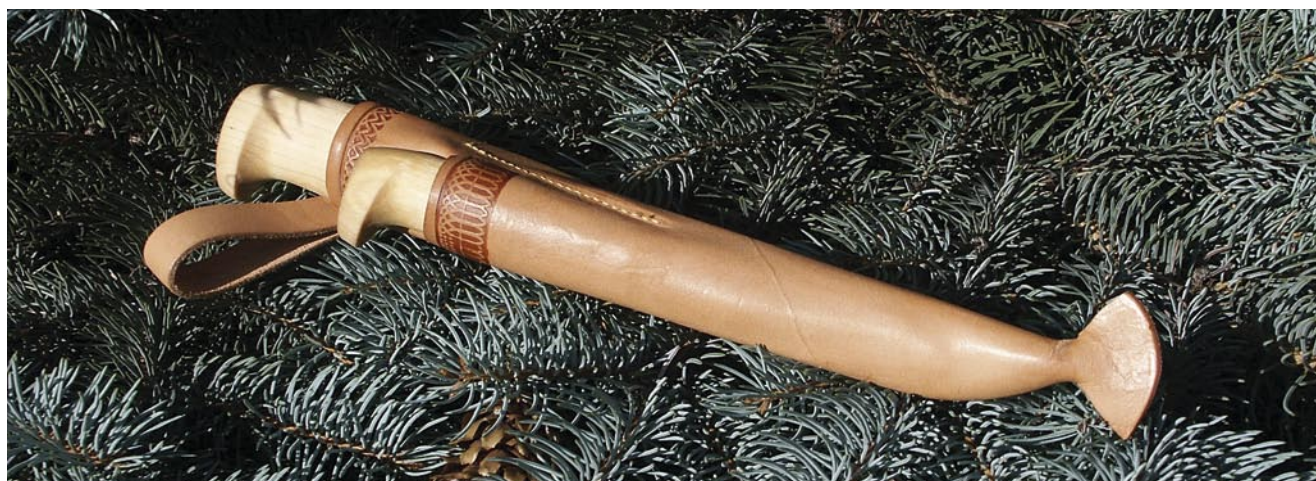
Фото 8. Фирма Iisakki предлагает сдвоенные ножи. Гнезда для ножей разнесены друг от друга, располагаясь не рядом и не «бутербродом», а под неким углом друг к другу. Достаточно сложно прошитая конструкция с кольцевым подвесом поясной петли. Ножи компактны и удобны в ношении с любой одеждой.
