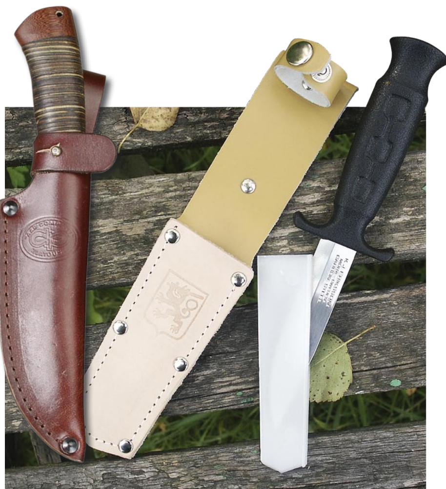
Фото 1. Варианты ножен с хлястиком. Златоустовский «АиР» (слева) важность качественных ножен понимает и делает их так, что рядом с импортными положить не стыдно. Дополнительные кожаные проставки по периметру шва предохраняют его от разрезания при вкладывании ножа. Шведы эту проблему решают с помощью пластиковой вставки (справа).
