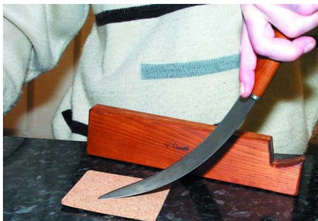
Возможно ли так согнуть напильник? Не пробуйте, не получится, а этот нож, сделанный из УНС, имеет твердость 66 единиц!
