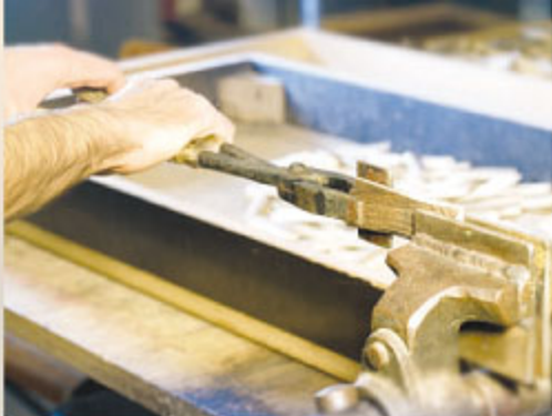
Bearbeitung der Griffschalen
