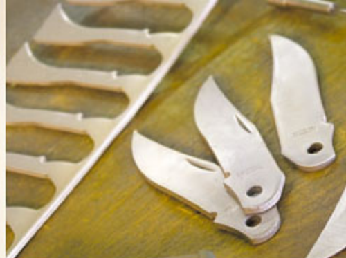
Grobes Zuschneiden der Platinen, Klingen und Backen
