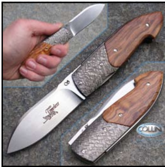
VIPER TIMELESS TITANO E OLIVO Art. 2584 € 105,00 • Acciaio: Sandvik 12C27 inox • Manico: titanio e legno di olivo • Lungh. lama: 70 mm • Spess. lama: 3 mm • Lungh. tot.: 168 mm • Chiusura: liner lock • Peso: 74 gr. • Note: design Fabrizio Silvestrelli.
