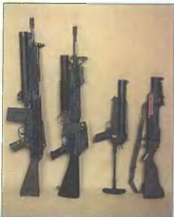
40-мм противотанковые гранатометы разных схем: Ручные М79 (США) и HK69A1 (ФРГ), подствольные М203 (на винтовке M16A1, США) и HK79 (на винтовке ПЗ, ФРГ)
