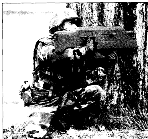
Макет двухкалиберного оружия (5,56-мм/30–35-мм) PAPOP концерна GIAT (Франция). Проектная масса комплекса — 7 кг
