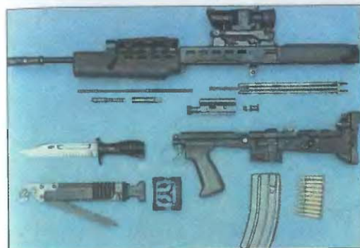
Неполная разборка винтовки L85A1 (Великобритания)
