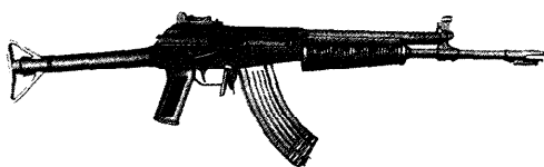
Финская штурмовая винтовка М62 «Вальмет»
