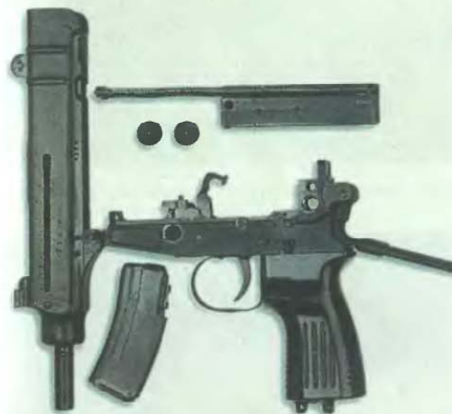
Неполная разборка пистолета-пулемета «Скорпион» Vz. 61 (Чехословакия)
