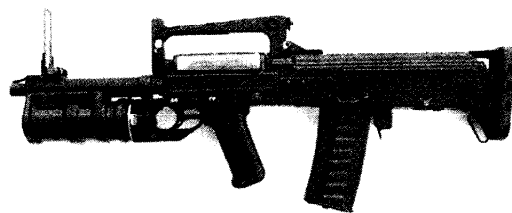
Оружие ОЦ-14 «Гроза» в варианте автоматно-гранатометного комплекса
