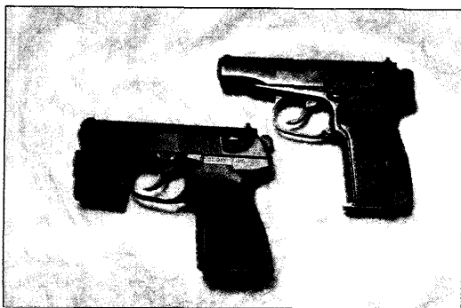
Пистолеты ПМ и ПММ (с лазерным целеуказателем)
