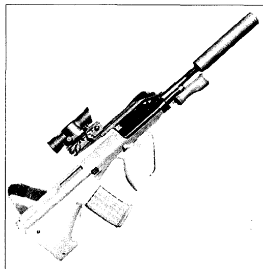
«Коммерческий» вариант винтовки AUG-77 «Штейр» с коллиматорным прицелом и глушителем
