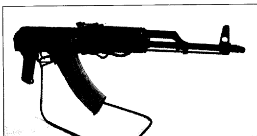
Автомат АКМС со сложенным прикладом
