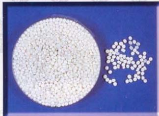
Ci-dessus. L'origine de tout, quelques granules de polystyrène. Chauffés ils deviennent liquides et peuvent donc être injectés, sous pression, dans des moules en acier.
