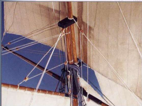
▶ łączenie kolumny ze stengą mainmast head, tressletrees, crosstrees and cap
