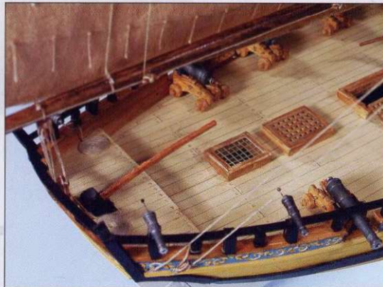
▶ łączenie kolumny ze stengą mainmast head, tressletrees, crosstrees and cap
