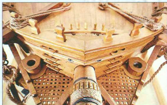
◀ Ubikacje i greting (kratownice) kosza dziobowego. Kotbelki były głęboko osadzone na pokładzie, a na towarzyszących im knagach obkładano liny do wciągania kotwic.
