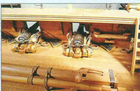
▲ Ława wantowa fok-masztu z przymocowaną do niej kotwicą. Podwężki wantowe - metalowe elementy łączące jufersy z poszyciem, musiały wytrzymywać duże naprężenia.
