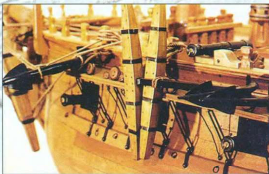
◀ Ubikacje i greting (kratownice) kosza dziobowego. Kotbelki były głęboko osadzone na pokładzie, a na towarzyszących im knagach obkładano liny do wciągania kotwic.
