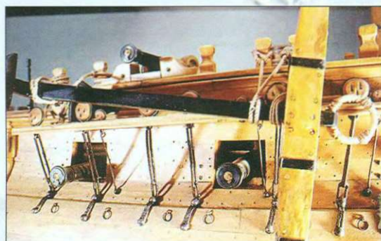
▲ Ława wantowa fok-masztu z przymocowaną do niej kotwicą. Podwężki wantowe - metalowe elementy łączące jufersy z poszyciem, musiały wytrzymywać duże naprężenia.
