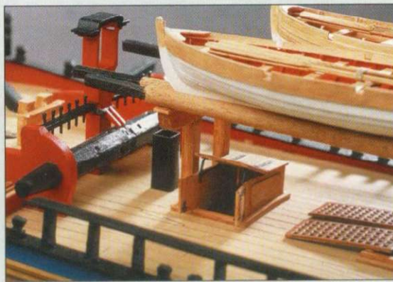
Burta okrętu: ława wantowa grotmasztu; uchylone kłapy otworów wentylacyjnych.
