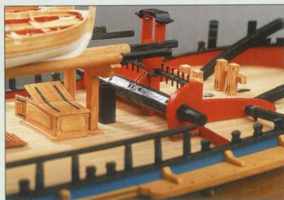
Fragment dziobówki i śródokręcia - widoczny jest kabestan, zejściówka i dzwonnica.
