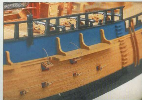
Burta okrętu: ława wantowa grotmasztu; uchylone kłapy otworów wentylacyjnych.
