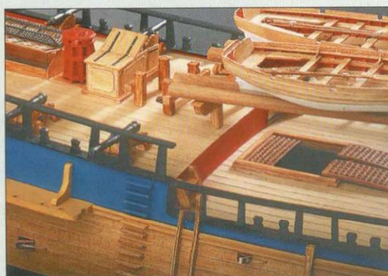
Fragment dziobówki i śródokręcia - widoczny jest kabestan, zejściówka i dzwonnica.
