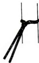
RYS. 31 SPOSÓB WIĄZANIA WANT MASZTÓW.
