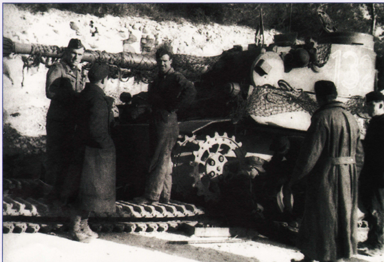
Танк «Тигр» № 132 501-го тяжелого танкового батальона во время ремонта. Механики заняты гусеницами и элементами подвески. 48 колес и 96 звеньев каждой гусеницы были слабым местом грозного танка.
