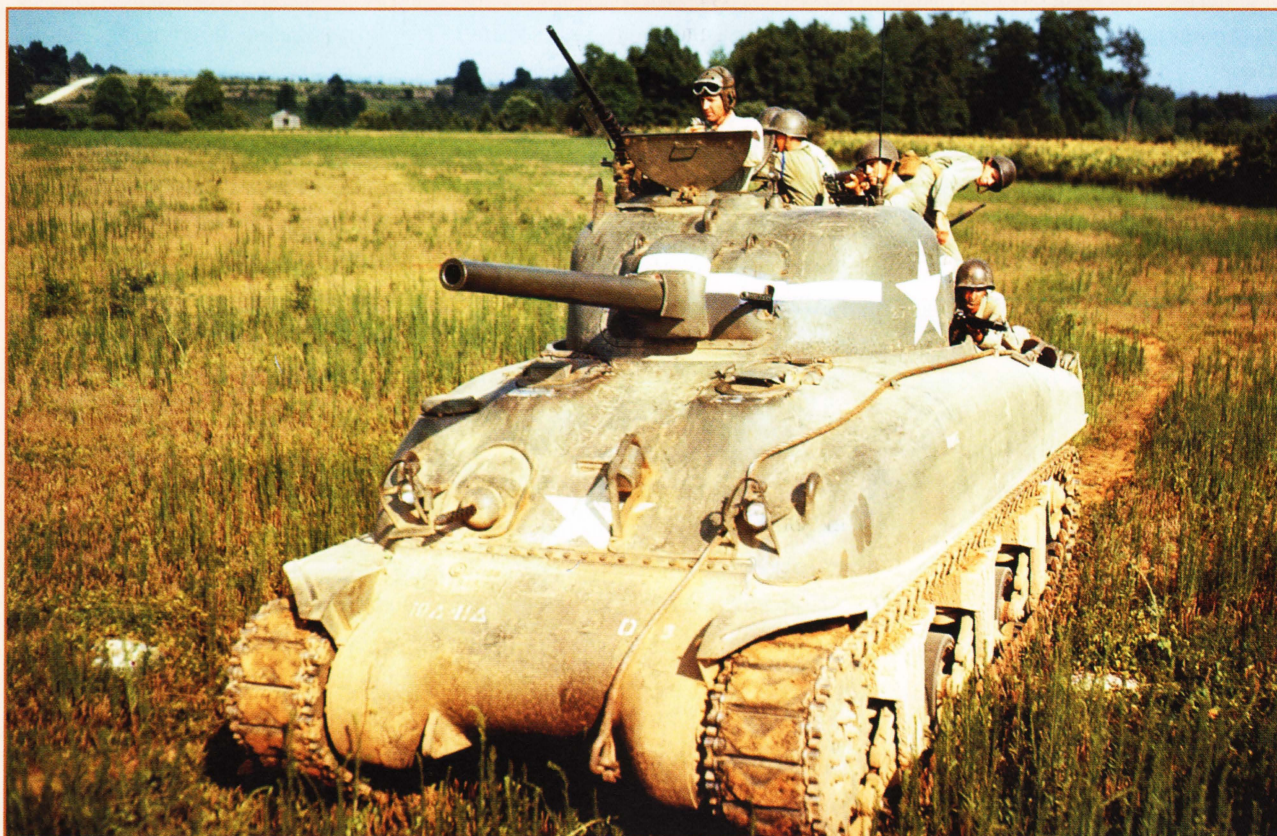
Эта фотография сделана во время маневров в США весной 1944 года. Видны корпус и литая передняя часть танка, машина сохранила частичное щитовое прикрытие башни первого типа.
