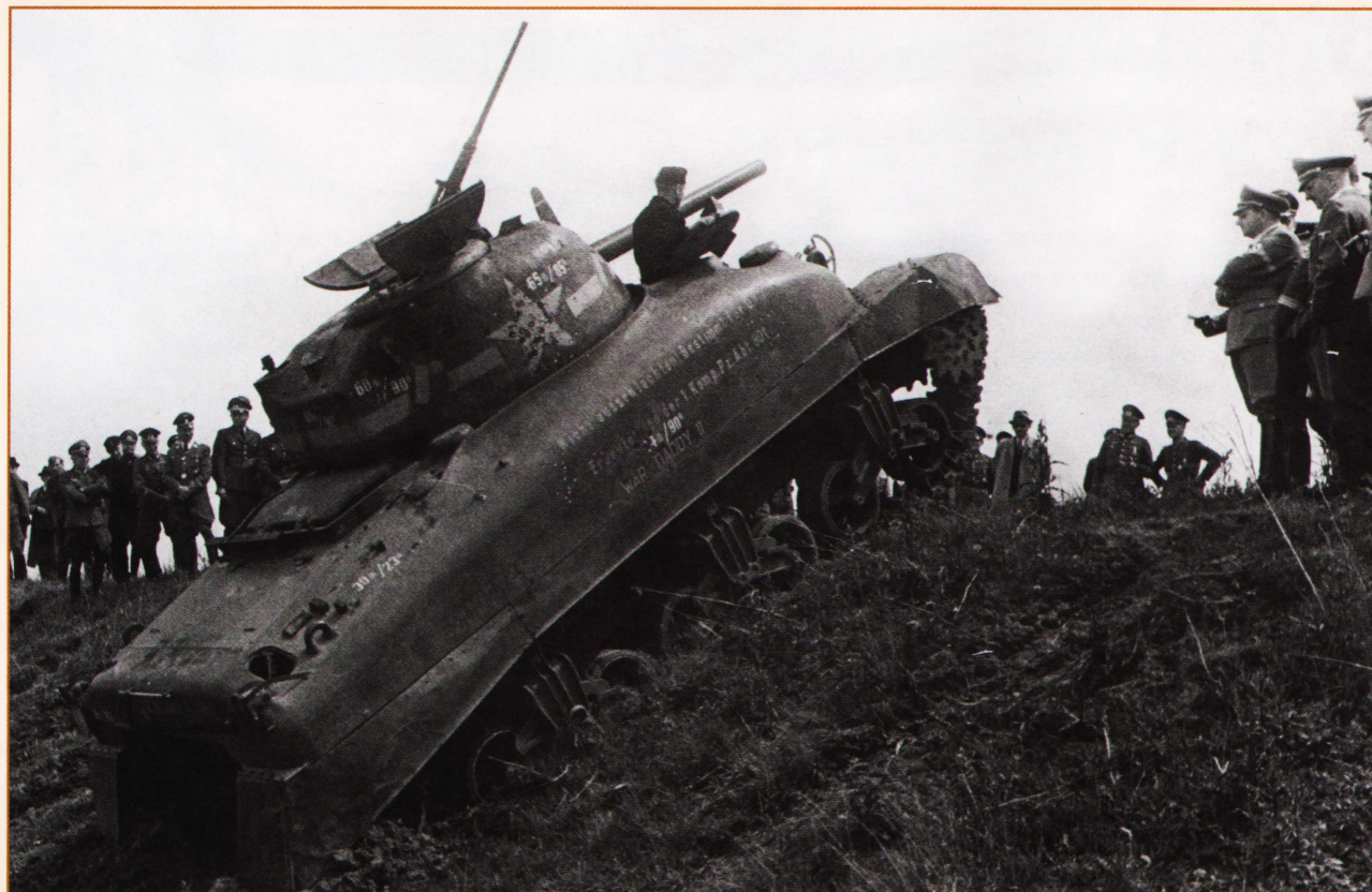
М4 «Шерман», захваченный немцами, проходит испытания в присутствии экспертной комиссии. Корпус машины полностью литой, танк сохранил крылья, которые отчасти гасили клубы пыли в пустынных районах Северной Африки.
