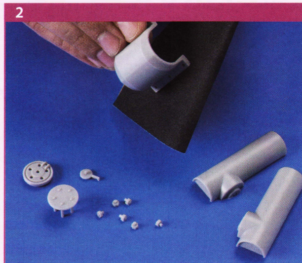
2 Мелкой наждачной бумагой зашлифуйте шероховатости на поверхностях деталей.
