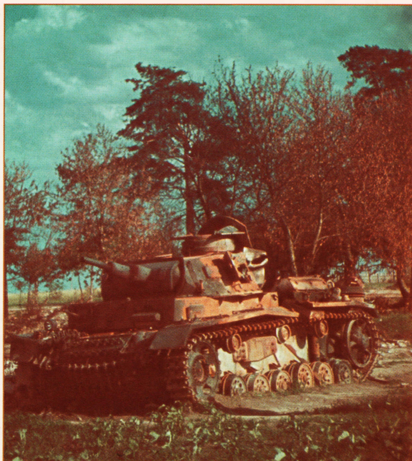
Подбитый танк Panzer III Ausf G с короткой пушкой калибра 50 мм на русском фронте, август 1941 года. На фотографии виден контейнер, закрепленный на башне, это так называемый «Rommelkasten» — «ящик Роммеля». Две боковые створки башни открыты. Звенья гусеницы спереди установлены, чтобы создать дополнительную «броню». На русском фронте Panzer III сильно уступал танку Т-34.
