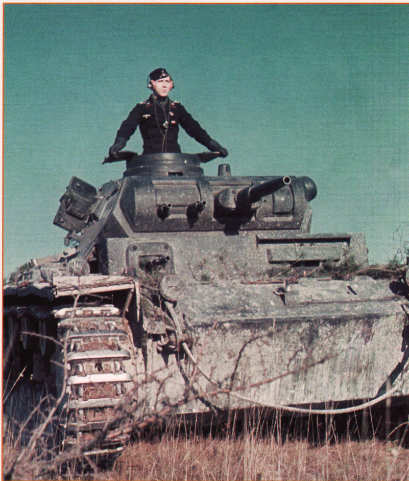
Один из 350 танков Panzer III Ausf E во время французской кампании в мае 1940 года. Рядом с пушкой KwK L/45 калибра 37 мм на башне установлены два пулемета MG.
