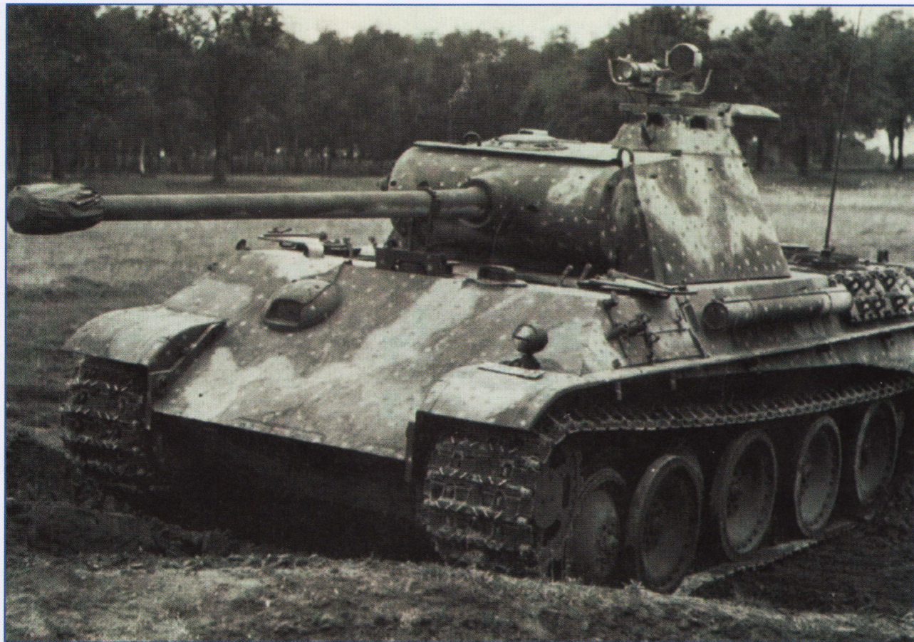
Танк Panther G, который в конце войны был оснащен пушкой KwK 42 L/70 калибра 75 мм и системой ночного инфракрасного видения, дополненной прицелом на командирской башенке. Несмотря на меньший, чем 88 мм, калибр, пушка L/70 изначально разработанная для опытной модели «Хеншель» VK. 4501 (H), характеризовалась такой же бронбойной силой.
