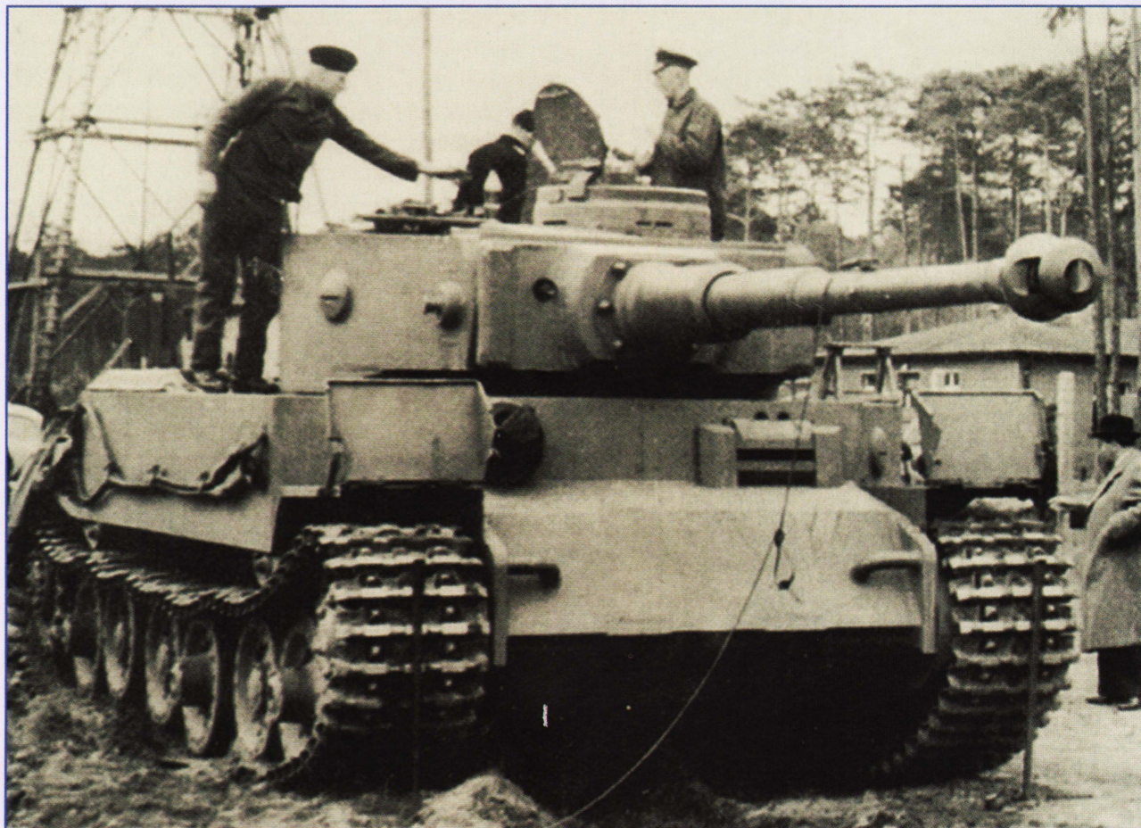
ВК. 4501 (Р) с башней, изготовленной компанией «Крупп», и пушкой калибра 88 мм, фотография сделана в начале июня 1942 года. Всего месяца спустя после серии испытаний все работы по строительству опытной модели будущего «Тигра», сконструированного фирмой «Порше», были остановлены в пользу модели компании «Хеншель», также принимавшей участие в конкурсной разработке.
