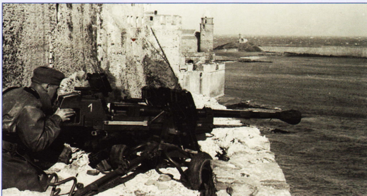
Солдат с противотанковым орудием калибра 28 мм с коническим стволом Schwere Panzerbüchse 41 наблюдает за входом в порт на юге Франции. Ствол пушки, разработанной компанией «Райнметалл», имел калибр 28 мм в казенной части, а скорость снарядов достигала 1400 м/с.
