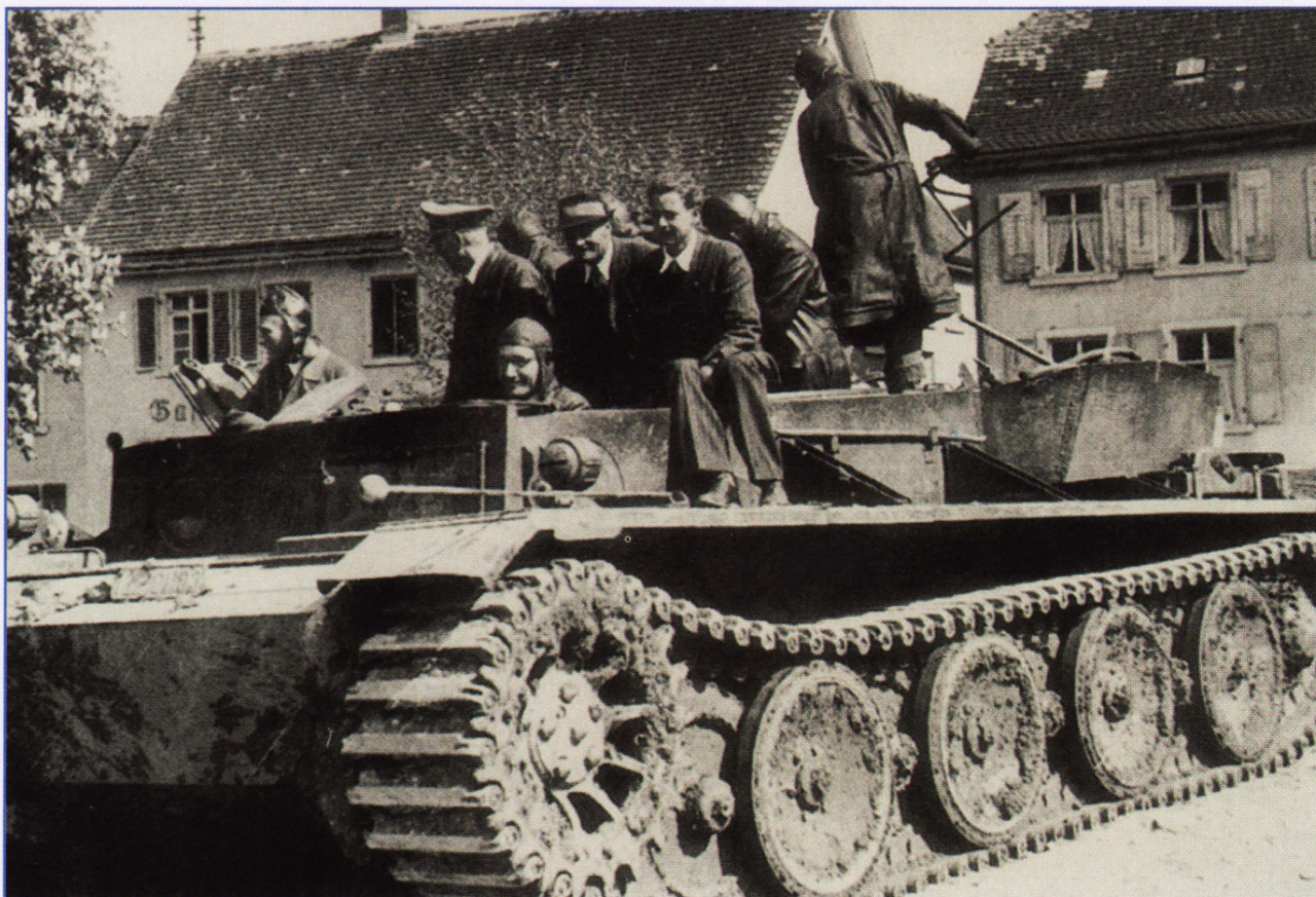
VK 3601 (H) в действии. На фотографии видна ходовая часть с 8 опорными катками, вставленными один в другой. Они прижимают гусеницу к земле, обеспечивая ее возвращение в верхнюю часть.
