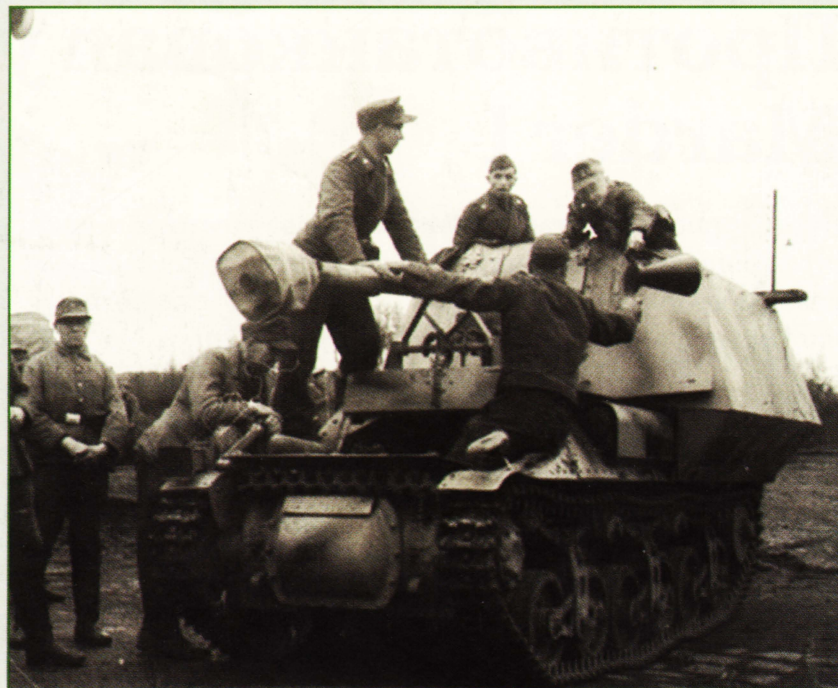
Marder I в боевой готовности после того, как его сгрузили с поезда. Фотография была сделана в Нормандии. Дульный тормоз закрыт колпаком, защищающим его от пыли и влаги.
