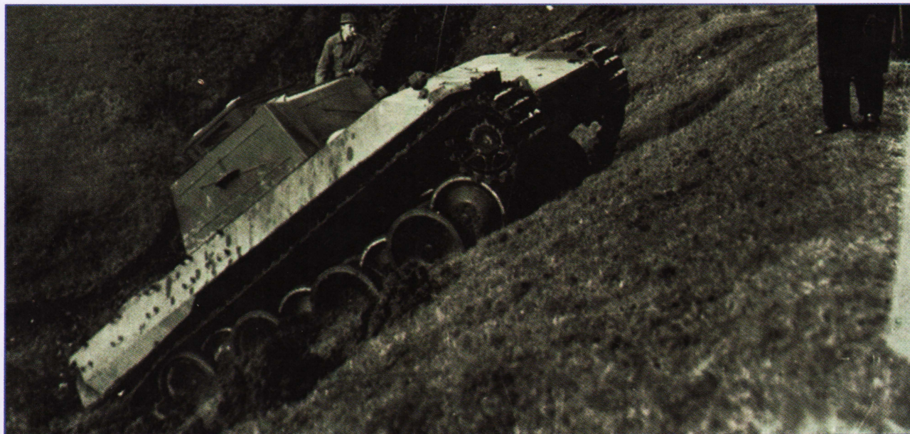
VK. 3002 производства компании MAN. Машина, которая послужила прототипом «Пантеры». Во время испытаний на испытательном полигоне производителя. 1942 год.
