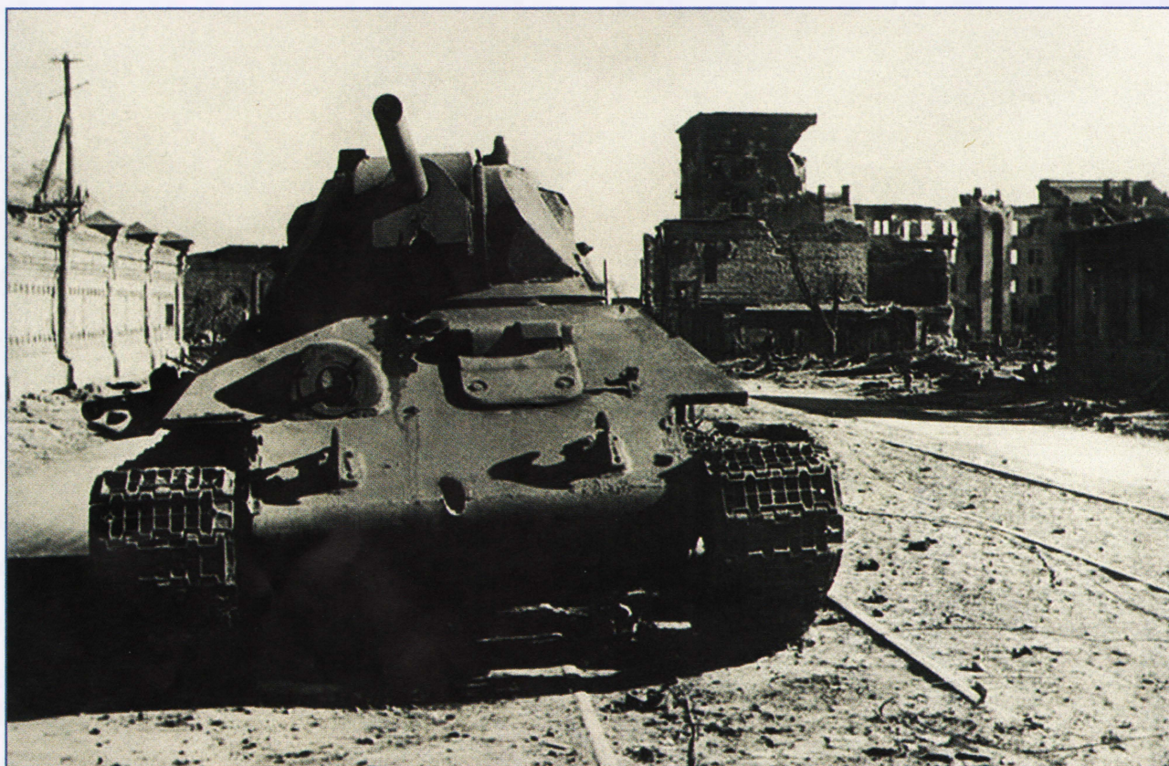
На снимке хорошо видно, что боковые поверхности танков Т-34/76 были покатыми. В октябре 1942 года танк получил снаряд в противотанковую защиту и пушку на улицах Сталинграда (сейчас Волгоград).
