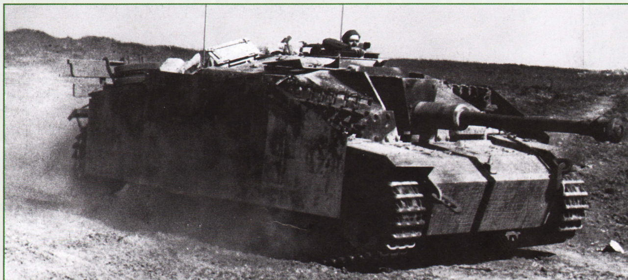
StuG III Ausf G в России. Эта модель отличается от машин предыдущих серий дополнительными броневыми экранами. Благодаря имкумулятивные заряды взрывались не достигнув бронирования.
