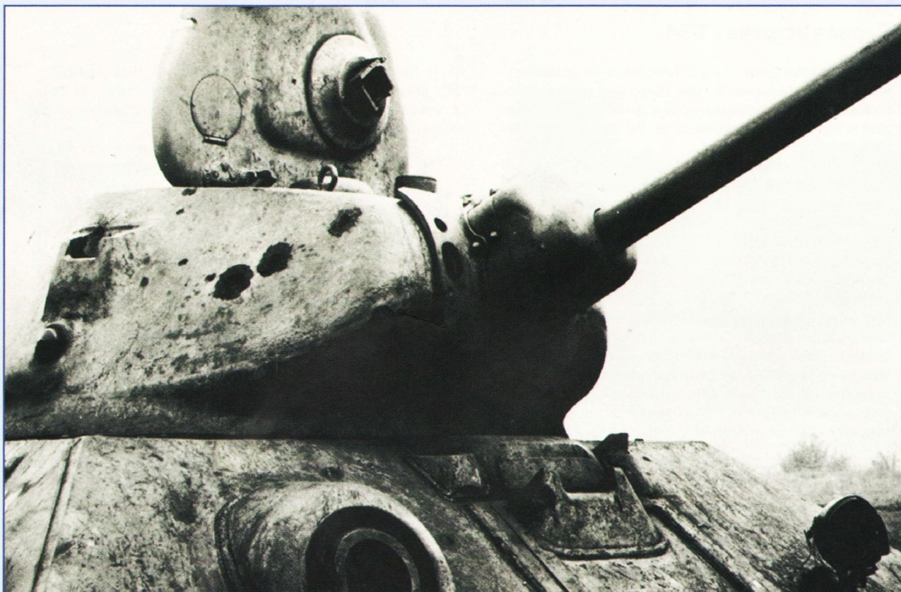
Т-34/76 модель 1940 года. В башню танка попало по крайней мере три снаряда. Конструкция командирской башенки была неудачной, так как люк открывался спереди, что делало невозможным передний обзор: чтобы посмотреть, что происходит впереди, командир танка приходилось полностью высовываться из танка и он оказывался под открытым огнем. Большую часть времени этот люк был закрыт, что ограничивало обзор поля боя.
