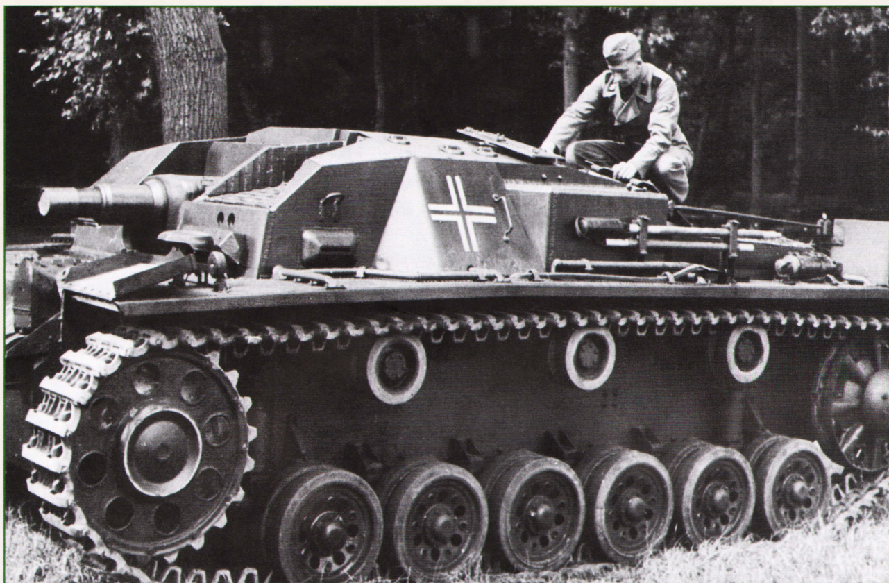
Установка StuG III Ausf A, вооруженная короткой пушкой калибра 74 мм, служила для поддержки пехоты, ее не применяли в противотанковых боях. Машину использовали во время кампании во Франции в мае 1940 года.
