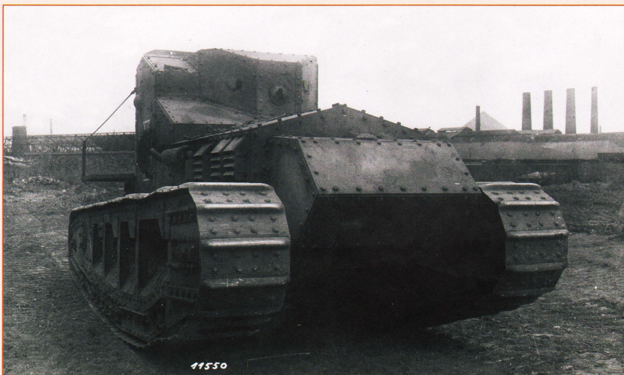
Средний танк Mark A, 1918 год. Двигатели располагаются в передней части корпуса под капотом. Боевое отделение находится в задней части. На этом танке были установлены классические гусеницы, а не гусеницы, огибающие весь корпус.
