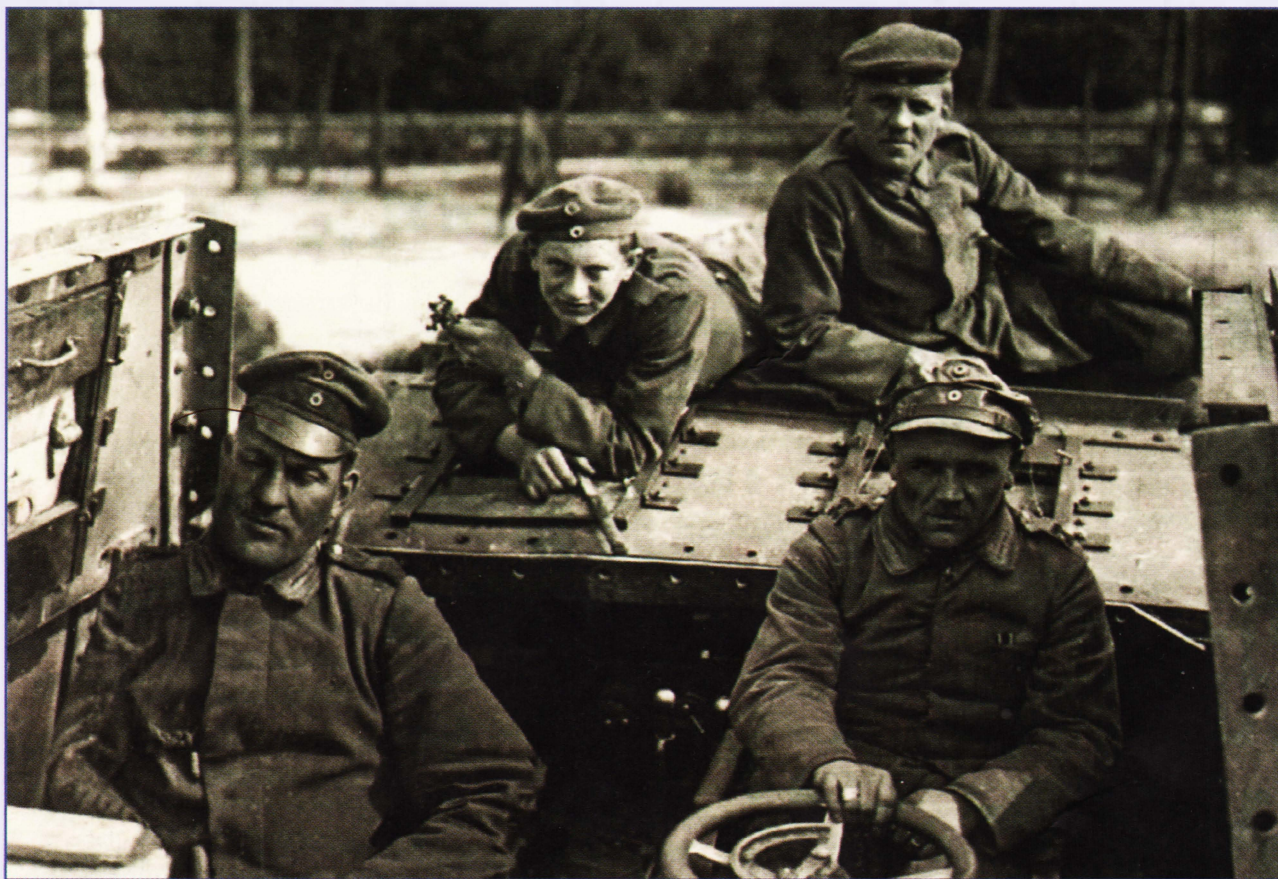
Члены экипажа 563 Wotan. Командир танка и машинист сидят рядом в чем-то вроде каземата, с которого здесь снята лобовая броня и крыша. Эту непрактичную конструкцию вскоре перестали применять.
