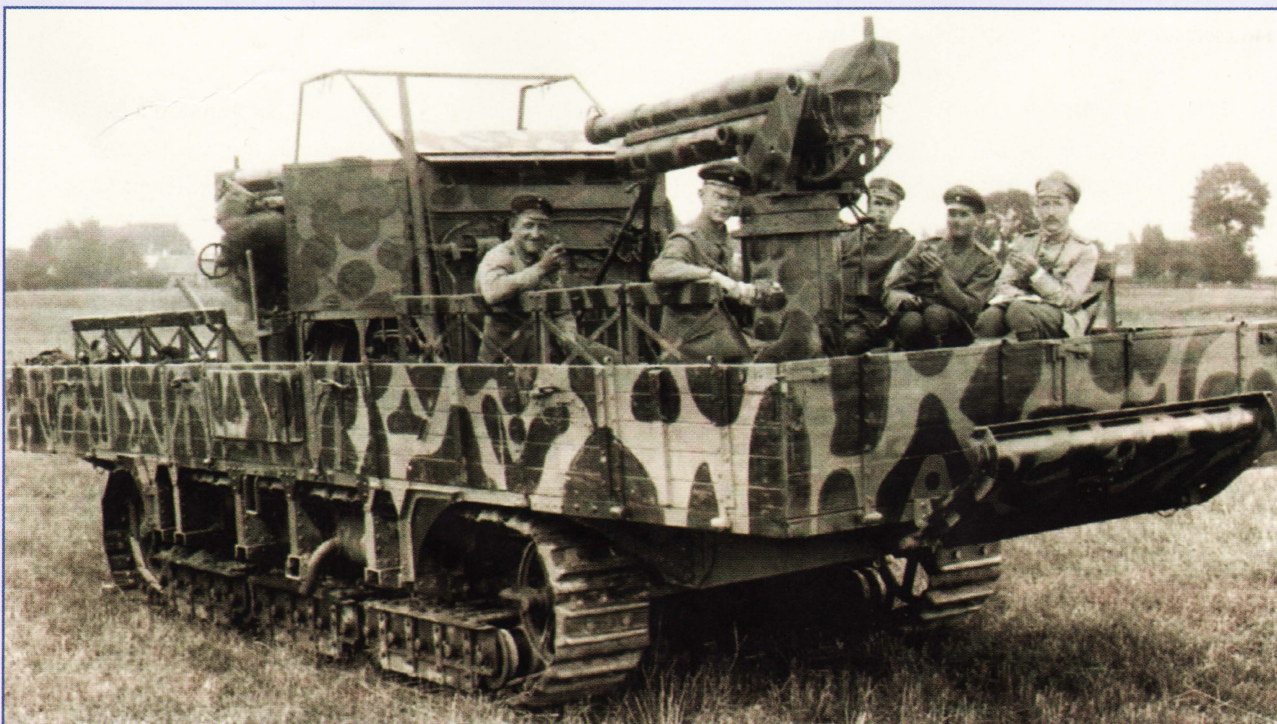
Raupenlastwagen (грузовик с гусеницами), который также называют Überlandwagen (вездеходная машина), используется здесь как реактивное зенитное орудие. Основа такая же, как у A7V. Около 75 этих основ, изначально задуманные как Sturmpanzer-Kraftwagen, были перестроены в машины для перевозки пушек и боеприпасов.
