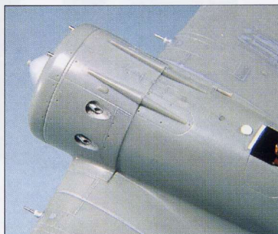
Las salidas de los escapes son pequeños tubos huecos conformados con limas.
