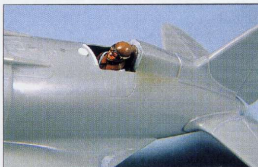
Con una tira de plástico se imita el protector de cuero para el piloto. La base del colimador es un pequeño disco de plástico.
