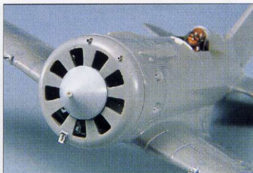
La toma de aire inferior del carenado se realiza con tiritas muy finas de plástico.
