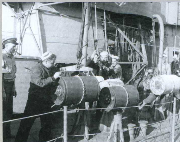
Wczesna wersja stanowiska K-Gun. Ładowanie bomby głębinowej Mk.6 na miotacz przy pomocy żurawika. Zdjęcie wykonano na niszczycielu USS "Roper" (DD-147) typu Wickes (flush-deck).
