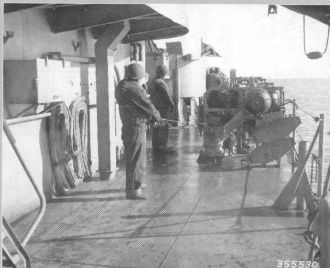
Późna wersja stanowiska K-Gun na jednym z niszczycieli eskortowych US Navy. Obsługa miotacza czeka na sygnał do strzału. fot. Internet
