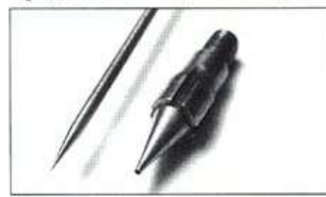
Обработанные игла и форсунка. Поверхности заполированы для лучшего сопереживания.
