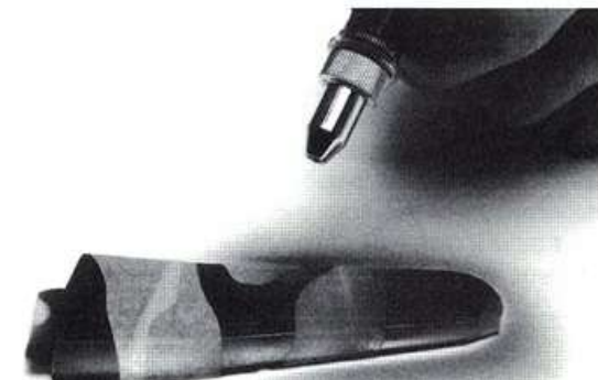
Для получения чётких резких границ перед нанесением следующего слоя краски используется специальный модельный скотч.
