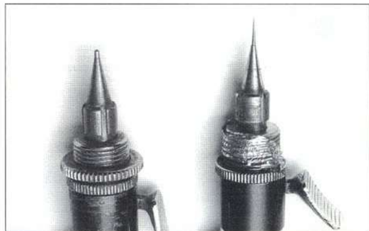
Аэрографы в сборе со снятыми насадками. Слева – со стандартной иглой, справа – с доработанной иглой, она заметно выступает из отверстия конуса. Фольга на резьбе позволяет хорошо держаться насадке и без фиксирующего кольца.
