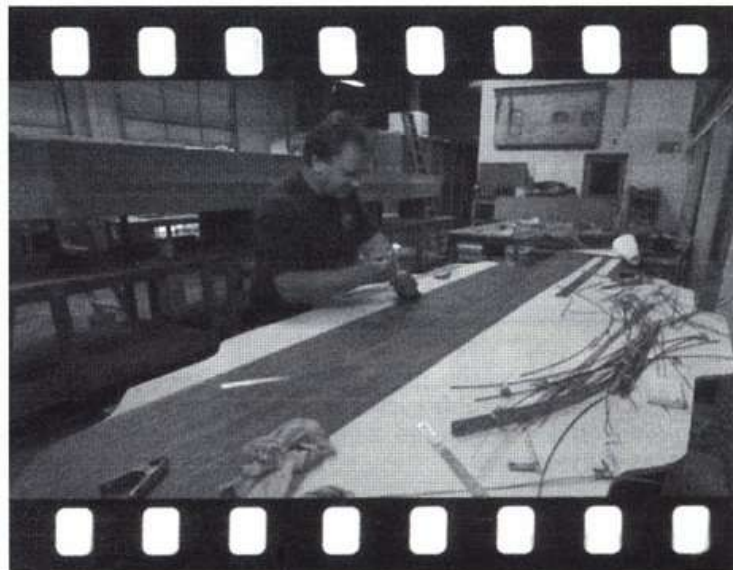
Дэвид Мерфи наносит тиковую облицовку на палубу модели. Тик нарезан лазером, независимо от волокон, используются полосуки шириной 3/16 дюйма (примерно 4.8 мм). Это придаёт крупномасштабной палубе натуральный вид.
