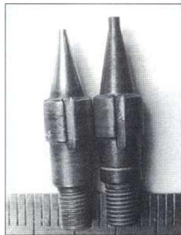
Кроме иглы, у аэрографа можно модернизировать и конус, сточенный самый наконечник.
