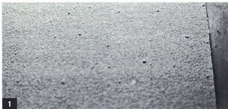
1 Наждачная бумага на тканевой основе. Обратите внимание на крупные зёрна абразива, вкрапленные в поверхность. Недостаток можно выявить лишь под острым углом направления света, а исправить его поможет стамеска, которой необходимо будет «срубить» включения. После чего эту НБ лучше не использовать для тонкой работы, но для снятия слоя пластика она вполне сгодится.
