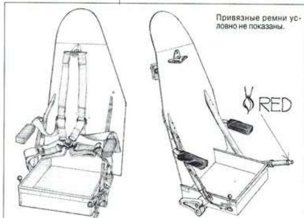
Рис. 4. Как видите в основном доработка кресла будет касаться подлокотников и изготовления из фольги привязных ремней.
