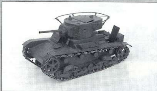
Жестяной Т-26 с гусеницами из браслетов от часов и электроприводом, М 1:35, 1987 год.
