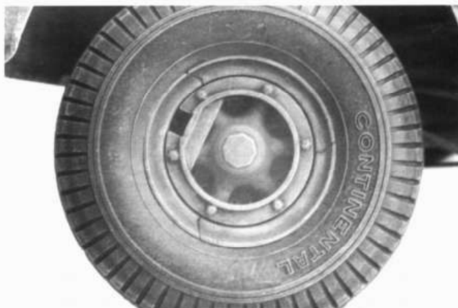
Диск колеса собирается из нескольких деталей, покрышка из мягкой резины.
