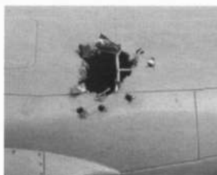
Выходная пробоина по левому борту с подклеенной по краям фольгой для имитации тонкой обшивки.
