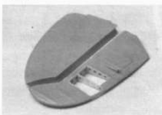
От стабилизатора отрезан руль высоты. У руля восстановлен носок, «содрана» обшивка и вклеен каркас.
