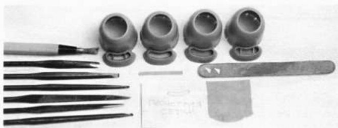
Мотоотсеки капотов: показан инструмент и стадии модернизации совка радиатора.
