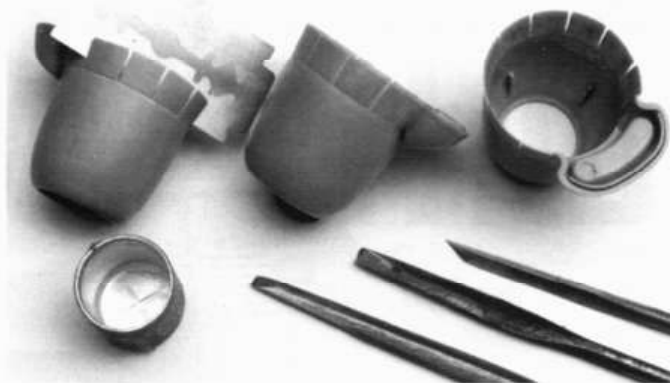
Мотоотсек капота двигателя. Невнятные линии края обшивки и замки капота необходимо проработать резцом. Створки юбки капота пропильны лезвием бритвы. Изнутри с лепестков снята лишняя толщина пластика. Показан инструмент, которым выполнена работа.
