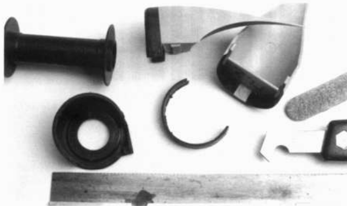
Верхние половинки задней части мотогондолы. Нарощенная часть мотогондолы легко ликвидирует щель (в положении отогнутых створок юбки капотов системы охлаждения двигателя). Ширина полукольца не более 4 мм.
