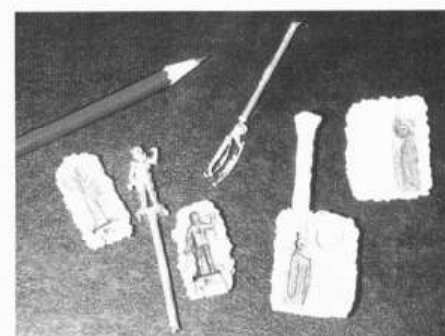
Примеры изготовления форм и отливок разных масштабов. Слева: рессоры для автомобиля в масштабе 1:72 крупным планом. Справа: формы и отливки рессор для автомобиля в масштабе 1:72 и фигурки в масштабе 1:48.
