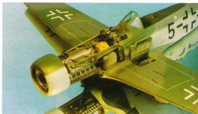
Носовая часть фюзеляжа. Хорошо видны крышка крылевого отсека вооружения и детализровка двигателя. В крыле видны отверстия для установки стволов пушки и кино-фото пулемета. В зеркале отражаются элементы ниши шасси, видны силовые элементы крыла (замок шасси еще не установлен). Изобилие пыли и царапин – проблемы местного КОДАК центра, не могу с ними бороться.
