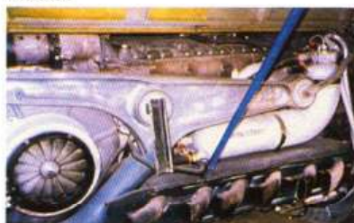
Двигатель Jumo 213, стержень мотора с правой стороны изогнут. Патрубки закрыты штампованными панелями
