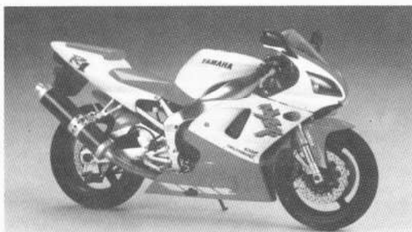
1:12 Yamaha YZF-R1, TAMIYA 14073. Сумасшедшая мощь его литрового двигателя (110 kW) потребовала установки специальной системы выхлопа EXUP с компьютерной регулировкой. А то всё повывлетало бы в «трубу»!
