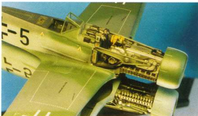
Двигатель был доработан. Хорошо видны храповик стартера, теплообменники (отражаются в зеркале), емкости системы охлаждения и круглые штампованные технологические крышки. Стержень мотора изогнут, он огибаает вход нагнетателя. За кабиной пилота в открытом отсеке радиооборудования виден пистолет.
