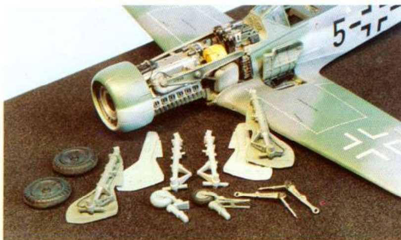
Элементы шасси. Хорошо видны замок шасси, рычаг подкоса основной стойки и пружина системы аварийного выпуска шасси
