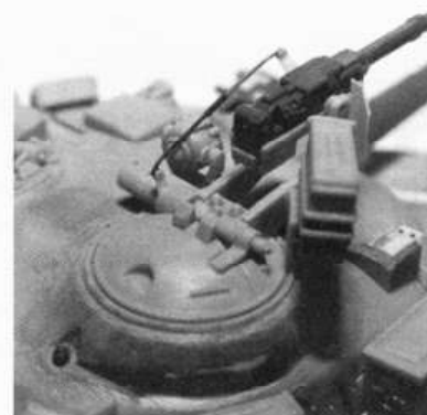
Командирская башенка, бронировка вокруг командирского люка, тяга для пулемета.
