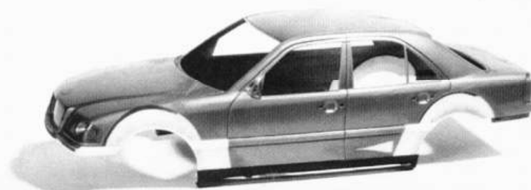
В доработанный кузов вклеены самодельные фрагменты крыльев, пороги взяты от Mercedes 600 SEL.
