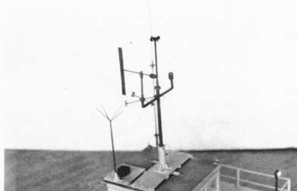
Крыша будки: флюгер, чашки датчика анемометра, штыри указателей сторон света с буквами «N-S-T-W», маяк, основание для стойки кронштейна, антенна.
