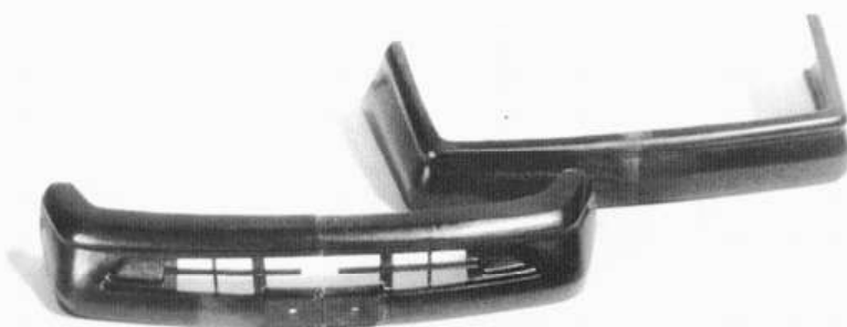
Разрезанные, укороченные и заново склеенные бамперы.
