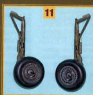
11 et 12 - Le train principal du Greif était très particulier car composé en fait de deux jambes se rétractant chacune séparément dans l'intrados.
