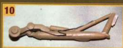
10 - Chaque jambe du train a été équipée d'une durit de frein réalisée en fil métallique.
