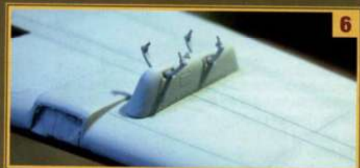
6 - Avant de recevoir leurs bombes planantes, les pylônes alaires doivent être détaillés et correctement collés sous l'intrados.
