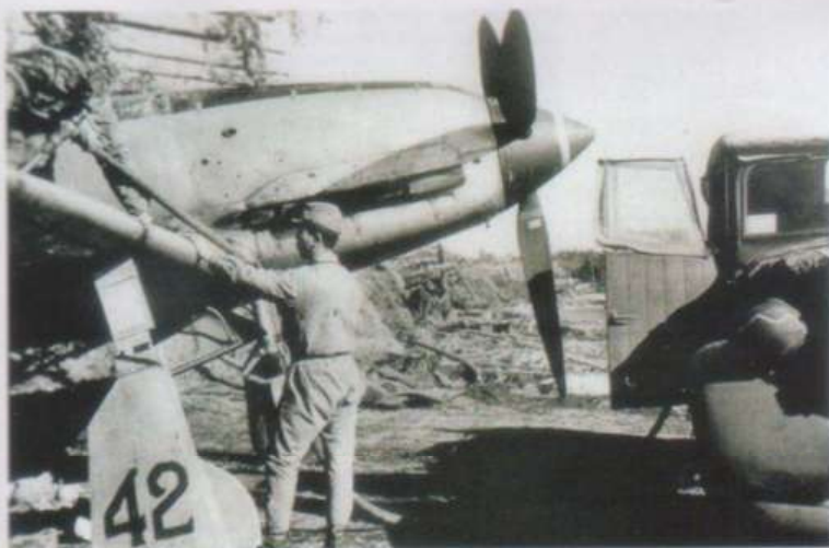
Ci-dessus. Ravitaillement du Ki-61 I, code 42, du 244 e Sentai. Le Hien emporte 550 l de carburant en réservoirs internes. (DR)
