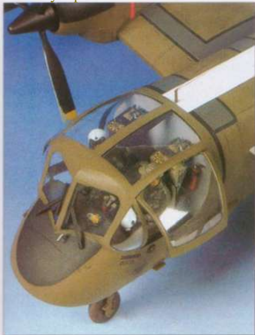
Ci-dessus. Gros plan sur le cockpit donnant à voir certains détails caractéristiques comme les essuie-glaces, les panneaux vitrés s'ouvrant vert le haut et l'excellente visibilité dont bénéficiait l'équipage.
