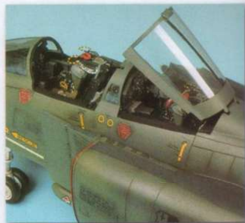
Ci-dessus. La canopée avant ôtée laisse voir le détail du poste principal, le haut du siège notamment, avec ses deux poignées d'éjection.
