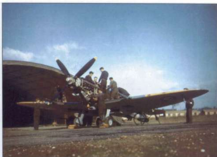
Ci-dessus, à gauche et à droite. Scènes d'entretien de Spitfire Mk. IX dont tous les panneaux de nez sont ôtés. (IWM)
