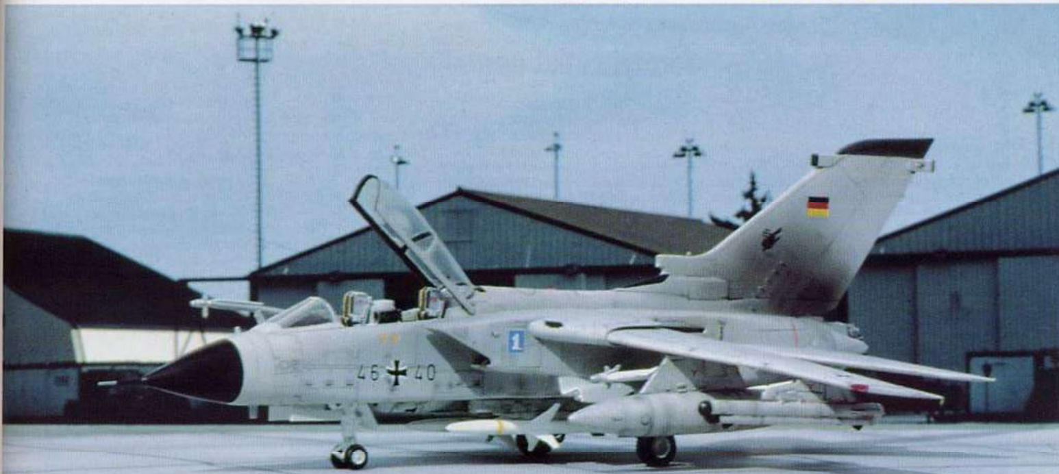
Typisch für den ECR-Tornado ist die Bewaffnung mit zwei AGM-88 HARM Raketen. Unser Modell trägt "scharfe" Waffen, was an den gelben Markierungen zu erkennen ist.
