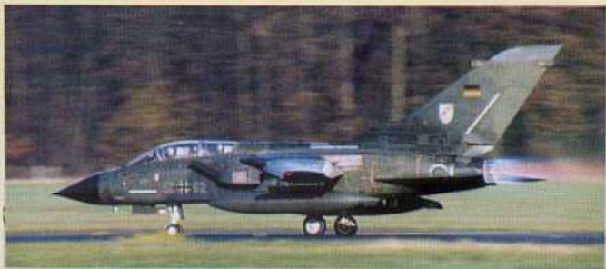
Auffällig an dieser Maschine des JaboG-31 sind die Antikollisionsmarkierungen an Leitwerk und Rumpf. (Matthias Becker)
