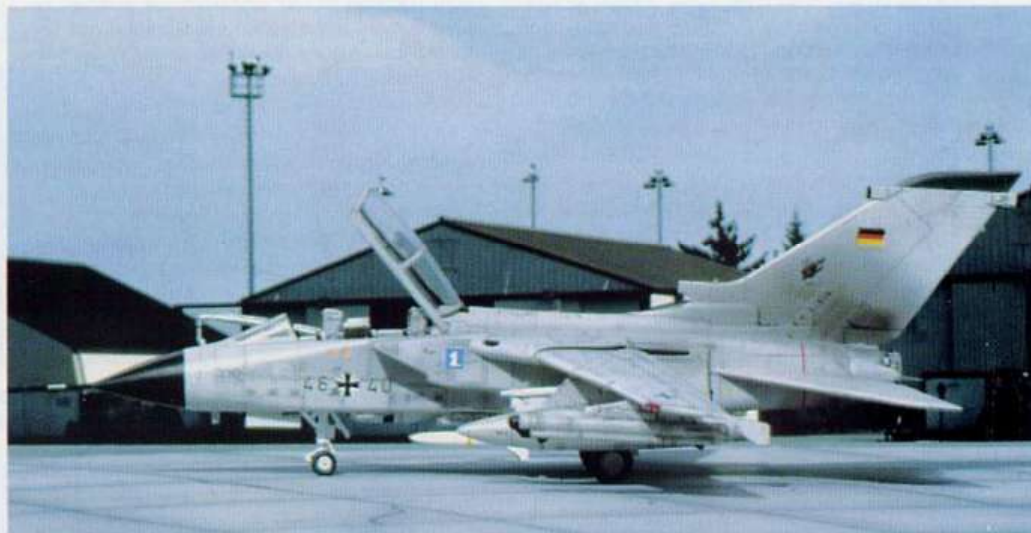
Typisch für den ECR-Tornado ist die Bewaffnung mit zwei AGM-88 HARM Raketen. Unser Modell trägt "scharfe" Waffen, was an den gelben Markierungen zu erkennen ist.
