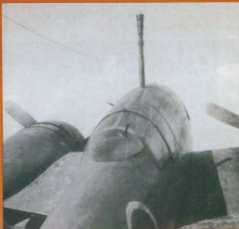
Ci-dessus. Gros plan du canon de 37 mm installé sur le dos de l'avion et sur le canon duquel l'extrémité du fil d'antenne vient se fixer. La peinture de l'avion est usagée notamment à la racine des ailes. (DR)
