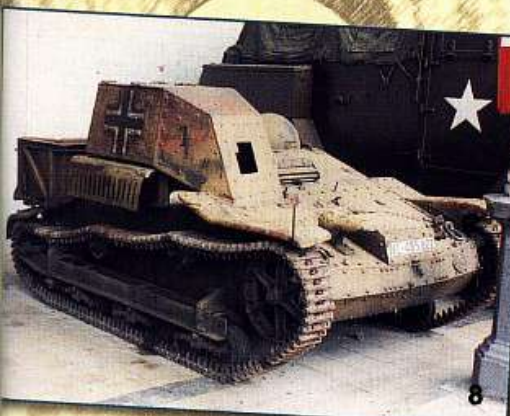
9 – Chenillette Renault UE modifiée par la Luftwaffe, avec son camouflage d'époque. Renault UE carrier modified by the Luftwaffe, in its genuine wartime camouflage.
