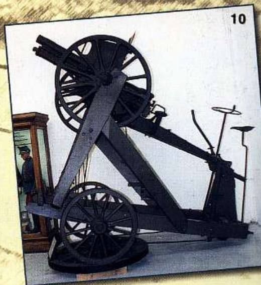
10 – Canon de 7,7 cm allemand avec affût improvisé antiaérien. German 7,7 cm gun with makeshift anti-aircraft mount.
