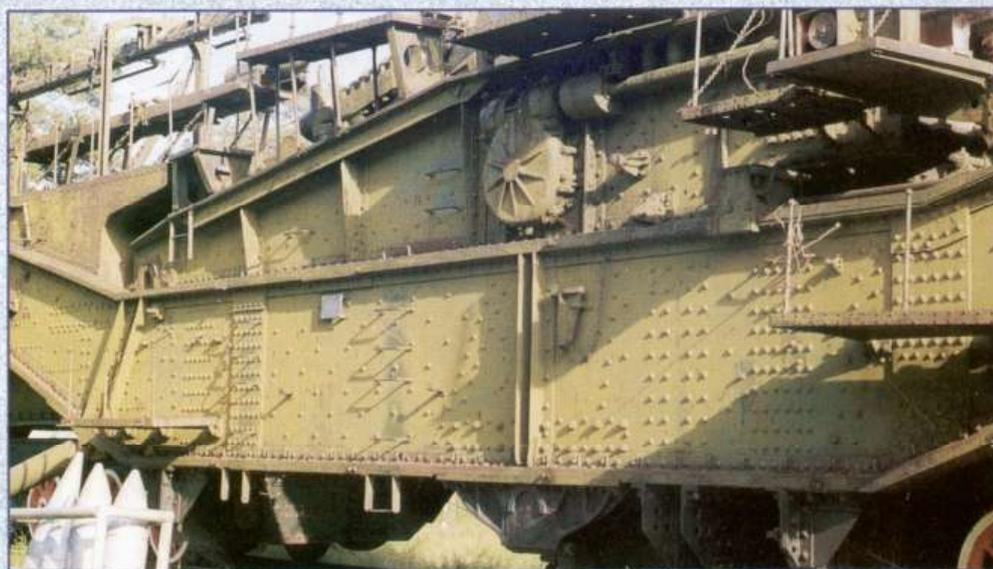
L'arrière de la plate-forme peuvent suivre le chemin de roulement. Chaque complexe comprend trois pas de tir en quinconce à 100 m les uns des autres, et une tour en béton de 28 m pour le contrôle de tir. Classiquement, une batterie comprend trois pièces, trois wagons munitions pour les charges, trois wagons munitions pour les charges, trois voitures stations électriques et une voiture poste de tir.
