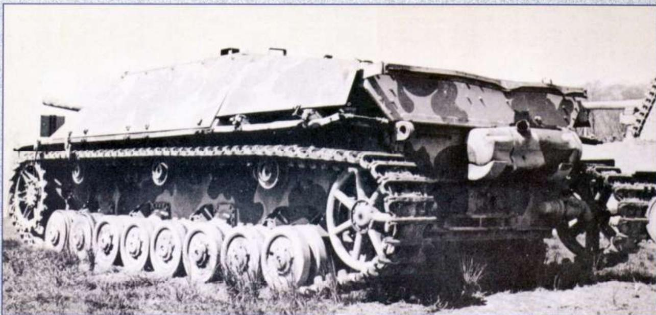
Il fut pris en charge par la SS-Panzer-Grenadier-Division Nordland en mars 1945. À l'usage, le Jagdpanzer IV lang se révèle bien plus puissant que son prédécesseur, mais moins maniable en raison de l'augmentation de poids (25,8 tonnes au lieu de 24) et de la longueur du canon. Le débattement réduit et le nombre moindre de munitions sont également des inconvénients qui ne seront jamais corrigés. □
