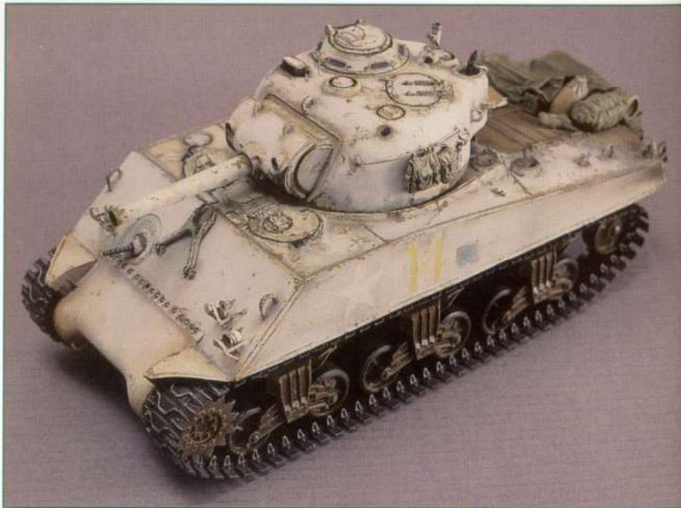
**Le M4A3 armé de l'obusier 105 mm diffère du Sherman standard par le tube plus épais, le mantelet modifié et le second extracteur de fumée sur le toit de tourelle.**
