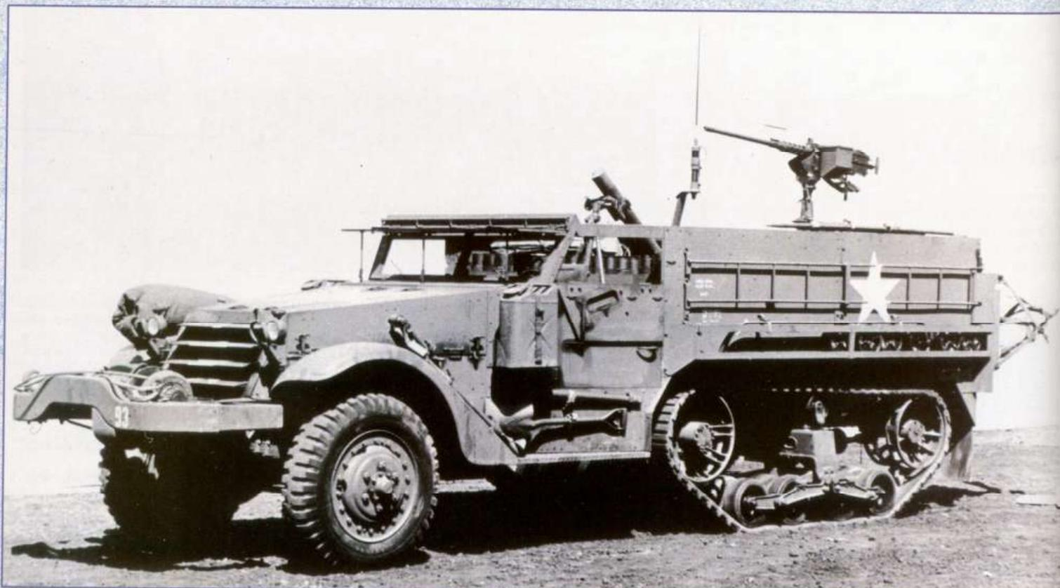
**A**fin de fournir un appui-feu adéquat à l'infanterie mécanisée et blindée, l'armée américaine décide en 1940 de concevoir, sur la base du Half-Track Car M2 alors en dotation dans ces unités, une variante équipée du mortier de 81 mm M1, dérivé du Brandt français. Le Mortar Carrier M4 est standardisé en octobre 1940, et emporte à son bord six hommes d'équipage (trois servants à l'arrière et trois sur
