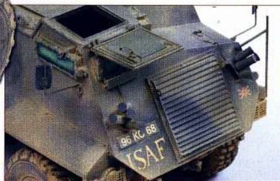
Ci-dessus. L'avant de l'engin montre différents équipements, tels les pots lance fumigènes dont l'installation est désormais généralisée sur l'ensemble des Saxon opérant en Afghanistan.
