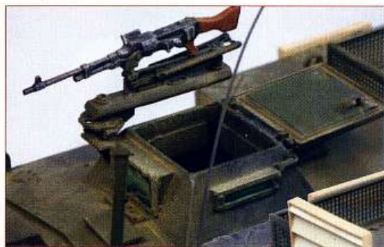
Ci-contre. Le système DISA supportant la mitrailleuse de calibre 7,62 autorise les tirs sur cibles terrestres comme aériennes.
