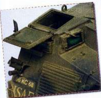
Ci-dessus. Le poste de conduite du pilote est relativement sommaire et très étroit, à sa gauche se trouve le puissant moteur permettant de propulser les 12 tonnes de l'engin à plus de 90 km/h.
