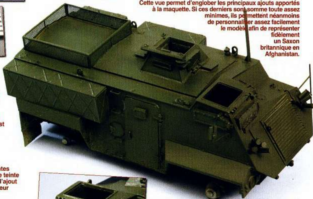
Ci-dessus et en bas de page, à gauche et à droite. La première phase de la mise en peinture consiste à recouvrir l'engin d'une généreuse couche d'apprêt, puis d'appliquer la teinte de base, le vert olive. Les bandes de camouflages sont réalisées avec un mélange de noir et de terre claire. Des photos d'engins en service m'ont servi de référence.
