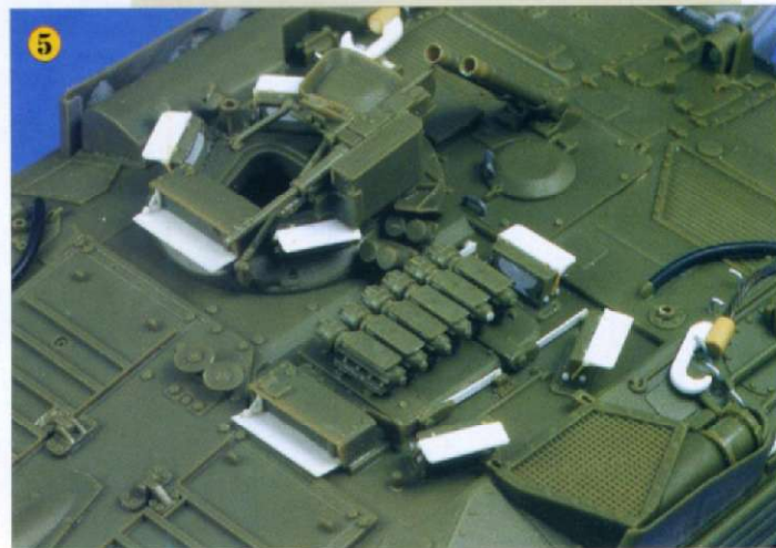
5. Sur la trappe double du poste du pilote et du radio on remarquera un rangement supplémentaire propre à la version tardive. Il s'agit des conteneurs pour les fusées éclairantes du système Lyran. Situés sur la trappe de visite de la culasse du canon on notera les deux lanceurs Lyran d'éclairage du champ de bataille. Leur embout est percé à l'aide d'un mini foret.
