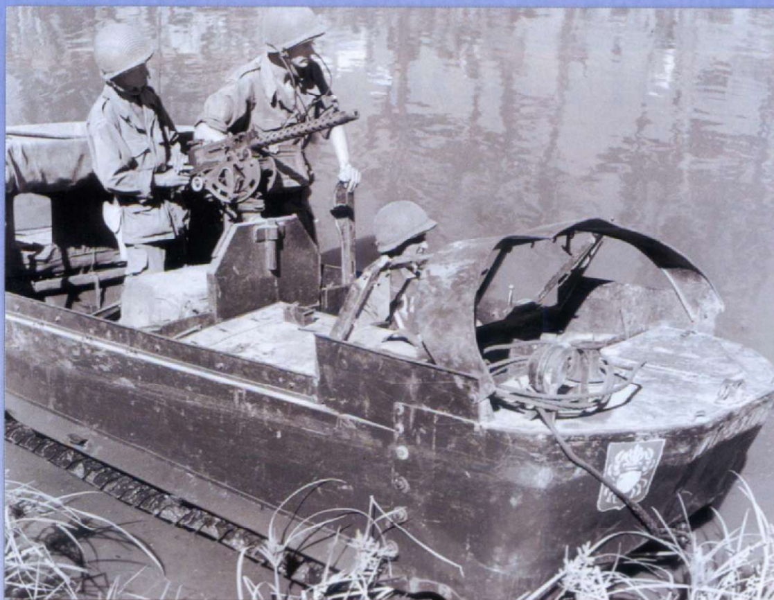
Ci-contre. Un Crabe en attente. Une mitrailleuse est ajoutée au centre de l'engin pour lui donner une bonne puissance de feu, mais l'équipage manque cruellement de protection, la mitrailleuse n'ayant même pas de bouclier.
