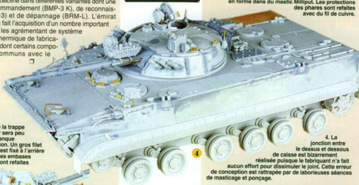
1. L'intérieur de la trappe du chef de char sera peu détaillée par manque de documentation. Un gros fillet de camouflage est fixé à l'arrière de la tourelle. Les embases des antennes sont refaites en micro-tube.
