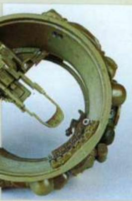
*Ci-dessus.* A l'intérieur de la tourelle Tamiya, les râteliers à obus sont remplacés par des pièces en photodécoupe Eduard. On pourrait également ajouter un panier de récupération des douilles sous l'arceau placé en arrière de la culasse.
