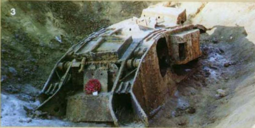
1. Sous cet angle, le char montre bien les dégâts causés par l'explosion de l'obus allemand qui l'a mis hors de combat. L'engin a été frappé par l'autre côté, mais le projectile a explosé en sortant.
