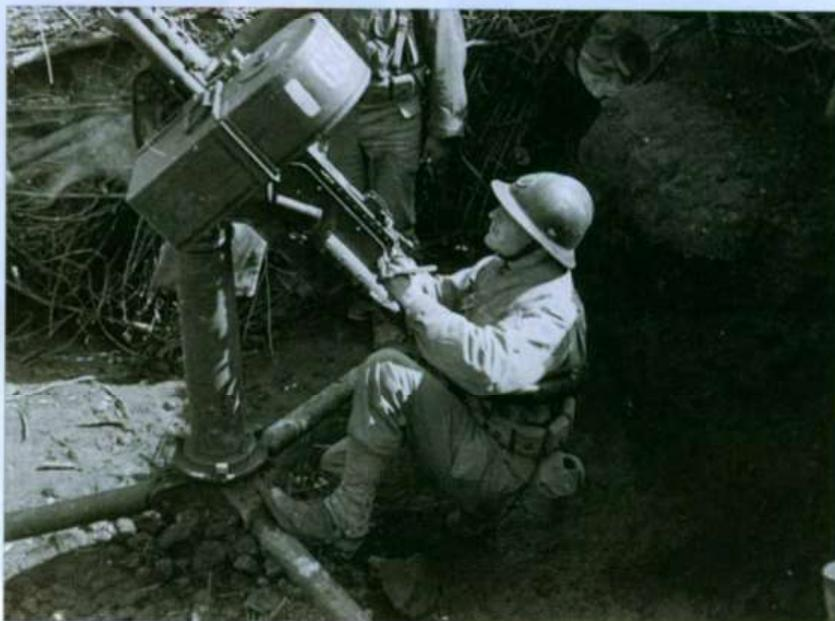
Sur route, le canon Bofors se déplace aisément à 30-40 km/h. Cependant, en raison de sa faible stabilité due à sa hauteur et surtout à la difficulté qu'il éprouve, une fois tracté, à prendre des tournants un peu serrés, il est dangereux de le pousser trop avant sur un itinéraire difficile ou insuffisamment aménagé.
