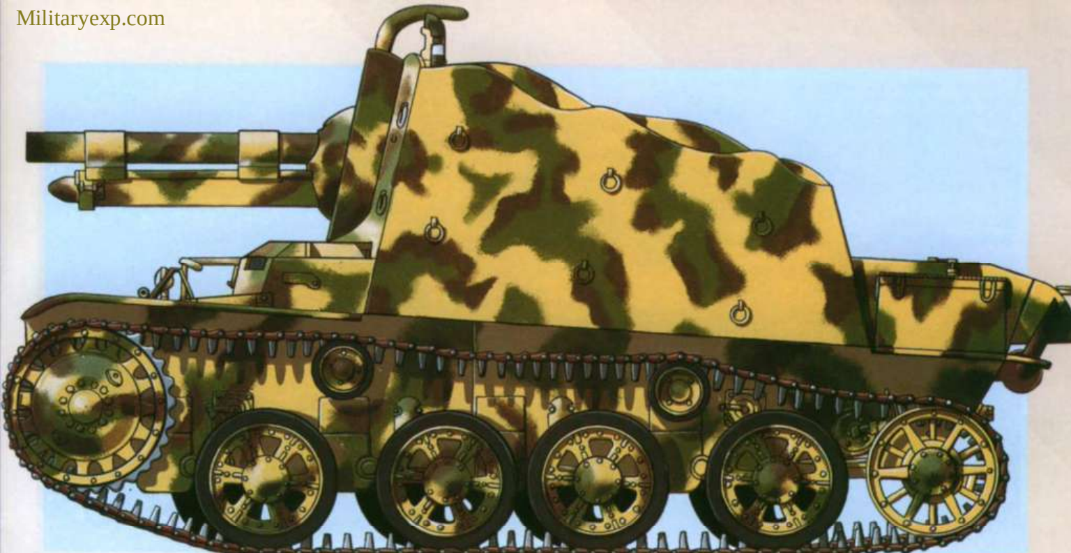
Ci-dessus. Landsverk 7,5 cm Provisorisk Stormkanonvagn (prototype) portant le premier type de camouflage. Cet engin sera repeint dans des tons plus foncés lors de sa conversion en 150 mm sans recul. Le modèle de nouveau camouflage figure sur la planche des marques de nationalité suédoises. (Illustration d'Hubert Cance, © SteelMasters 1998)
