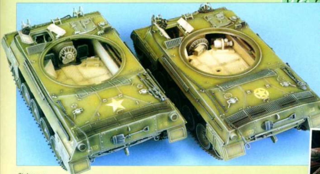
Ci-dessous. A gauche le M-18 AFV Club. Sa plage arrière est conforme au modèle réel (voir photos ci-contre et ci-dessous). En effet, les grilles de la plage moteur sont composées par une trame de gros fils d'acier soudés d'équerre. AFV a su cerner le problème de manière satisfaisante, d'autant que les ouvertures d'échappement transversales sont également présentes; elles ne sont pas figurées sur la maquette Academy. Le trépied replié pour mitrailleuse est trop court chez AFV Club.
