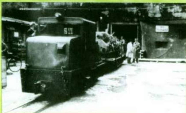
Ci-dessus. Toujours au Hochwald en 1944, un locotracteur Billard accouplé à des plate-formes Pechot pousse le convoi dans l'ouvrage. (Coll. J.-B. Wahl et P. Jost)
