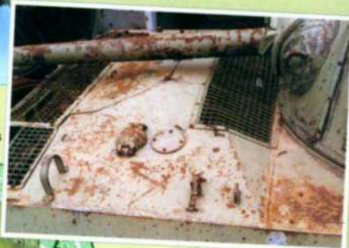
Ci-dessus. Gros plan de la plage arrière du char de Saumur montrant le grillage particulier des aérations et les ouvertures d'échappement. (Photo P. Anglaret)
