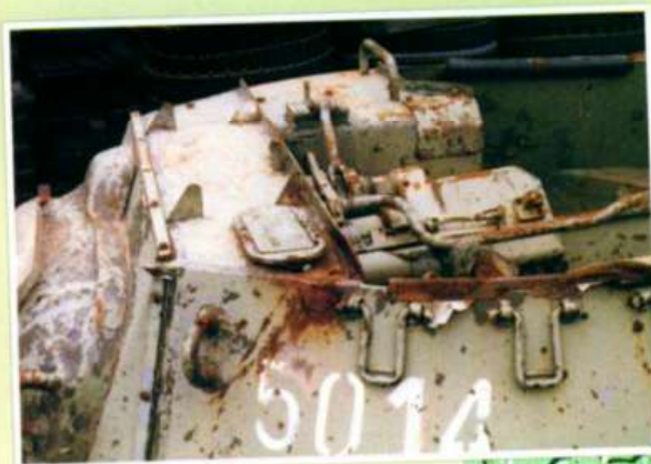
Ci-dessus. Autre gros plan de l'avant de la tourelle; la biellette mobile au dessus de la culasse maintient le canon en transport. (Photo P. Anglaret)
