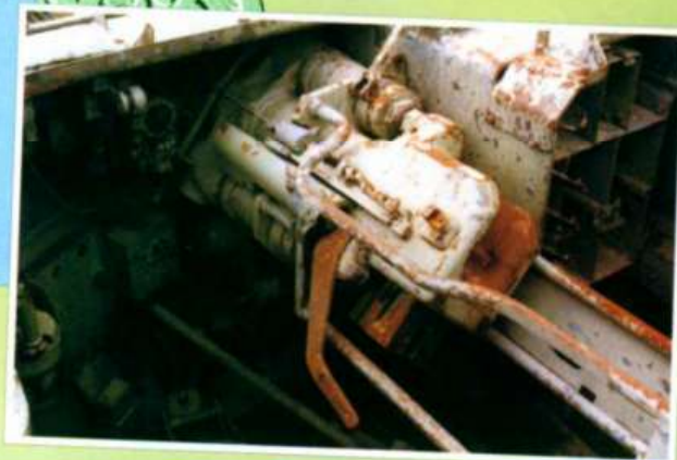
Ci-dessous. Vue de détail de la culasse et du coffre à obus. A l'aplomb du viseur, on trouve un boîtier de commande relié à la plateforme du tireur par un tube; cet équipement présent sur ce blindé capturé en Bosnie et actuellement conservé à Saumur est sans doute postérieur à 1945. (Photo P. Anglaret)
