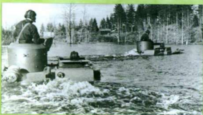
Ci-dessus. Deux T-38 en franchissement amphibie. La ligne de flottaison est si relevée qu'il ne subsiste pratiquement aucun bordé. Les détails de plage arrière ainsi que la différence des tourelles sont visibles.
