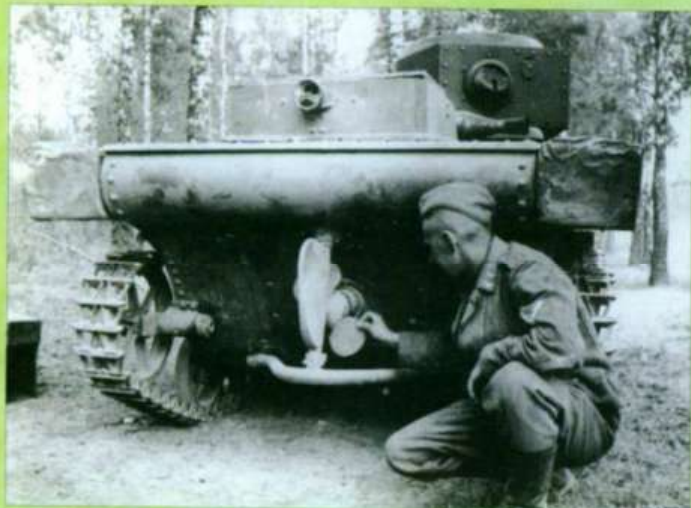
Ci-dessus. Un T-37 capturé par les Allemands. Cette vue est excellente pour le détail de l'arrière, notamment du système de propulsion amphibie.
