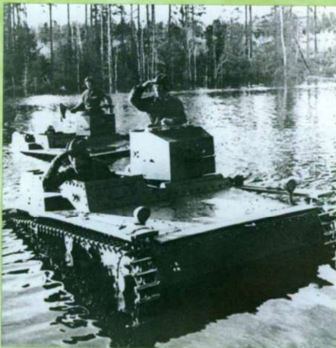
Ci-dessus. Deux T-38 en franchissement amphibie. La ligne de flottaison est si relevée qu'il ne subsiste pratiquement aucun bordé. Les détails de plage arrière ainsi que la différence des tourelles sont visibles.
